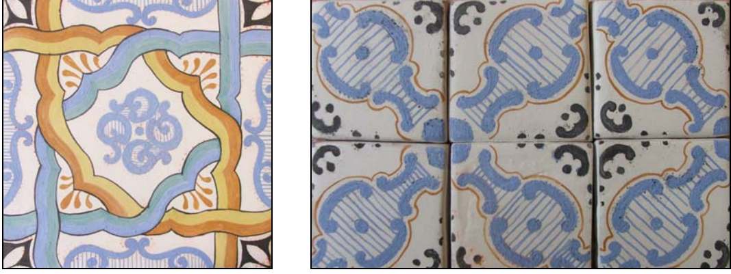
Fotoğraf 5-6. Sır altı pigment boyalar dekorlanmış plakalar
