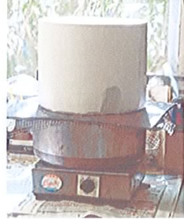
Resim 65 Balmumu modelin kalıp içinden buharı ile çıkarılması
