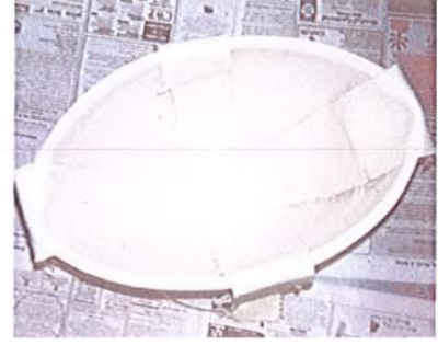
Resim 108: Seramik kalıp içine kumaş şeritlerin koyulması
