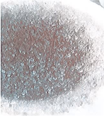
Resim 79: Fırınlama öncesi mangan oksitle Renklendirilmiş şeffaf cam parçacıkları.
