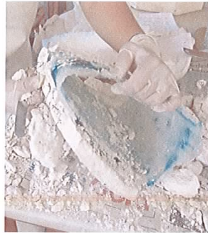
Resim 127- 128: Fırınlama sonrası kalıbın açılması
