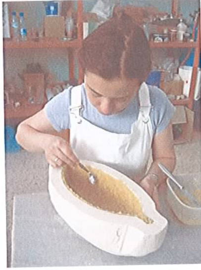
Resim 81 Cam parçacıklarının açık kalıplara yerleştirilmesi (Fotoğraf: Sema Okan)
