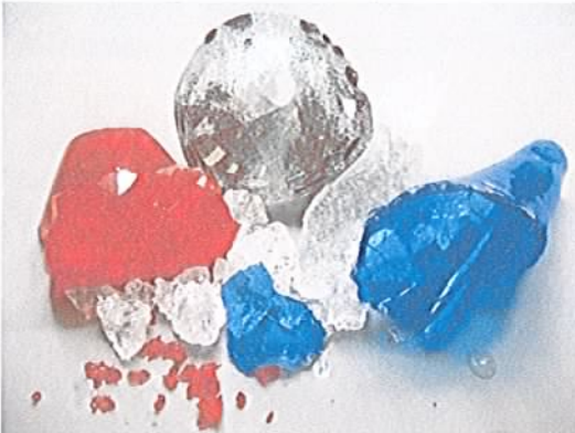
Resim 74: Camların termal şokla kırılması ve parçacık boylarının küçültülmesi (Fotoğraf: Sema Okan)
