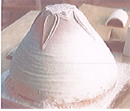
Resim 83: Cam hamurunu iç kalıp üzerine kaplanmış hali
