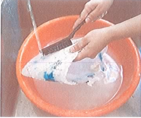
Resim 129: Kalıp içinden çıkarılan pate de verre objenin temizlenmesi (Fotoğraf: Sema Okan)
