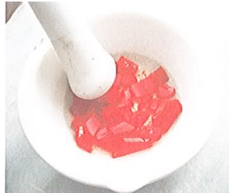
Resim 74: Camların termal şokla kırılması ve parçacık boylarının küçültülmesi (Fotoğraf: Sema Okan)
