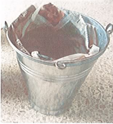
Resim 72: Camların fırında ısıtıldıktan sonra metal kovaya dökülmesi (Fotoğraf: Sema Okan)
