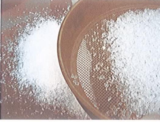
Resim 76: Cam parçacıklarını farklı tane boylarına ayırmak için yapılan eleme işlemi (Fotoğraf: Sema Okan)
