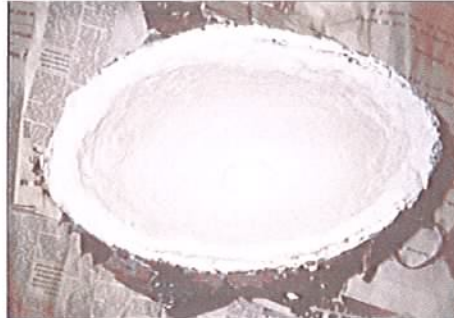
Resim 110: Fiber hamurunun kalıp içine sıvanması
