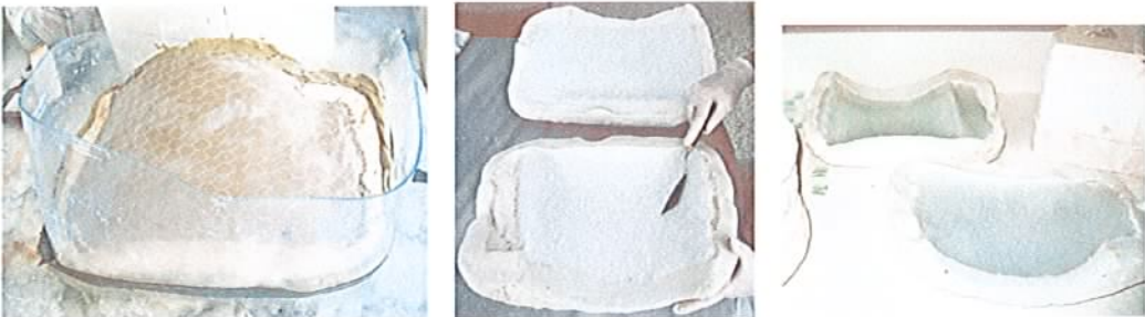
Resim 93–94–95: İki parçalı kalıpla pate de verre uygulama süreci,(Fotoğraf: Sema Okan)
