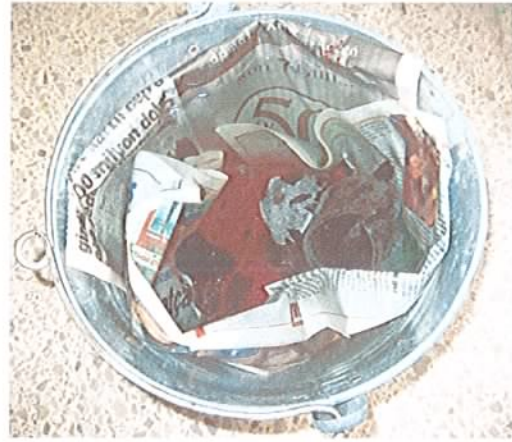
Resim 72: Camların fırında ısıtıldıktan sonra metal kovaya dökülmesi (Fotoğraf: Sema Okan)
