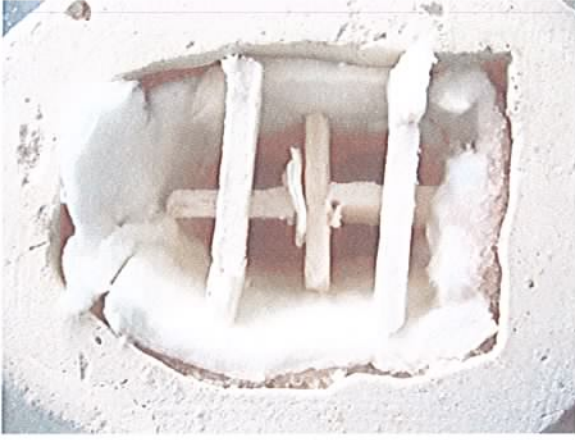
Resim 99: Kalıp içine cam parçacıklarının yerleştirilmesinden sonra seramik fiber battaniye ile desteklenmesi. (Fotoğraf: Sema Okan)
