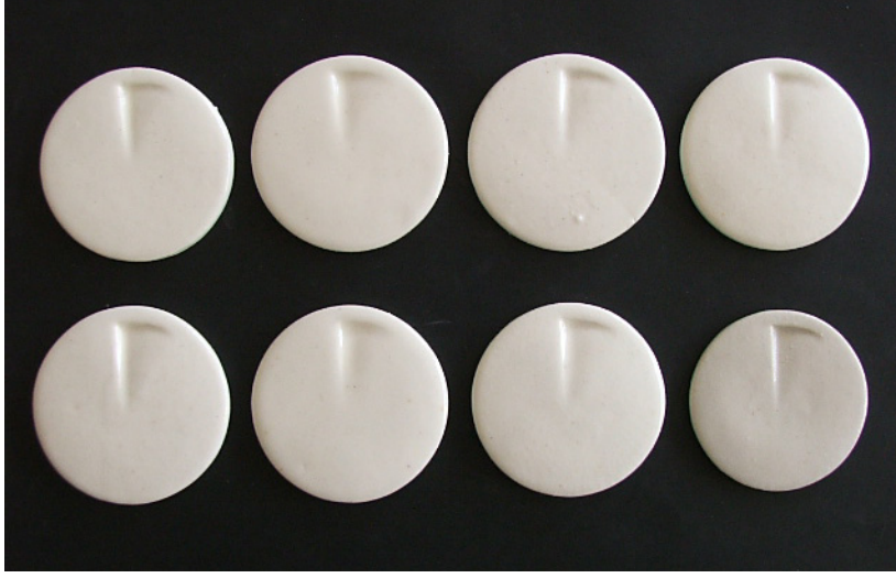
Resim 46: 9 no'lu sırnın 8 farklı bünyede uygulama sonuçları, soldan sağa: 1,2,3,4,5,6,7 no'lu bünyeler ve ESC 7Eczacıbaşı porselen bünye
