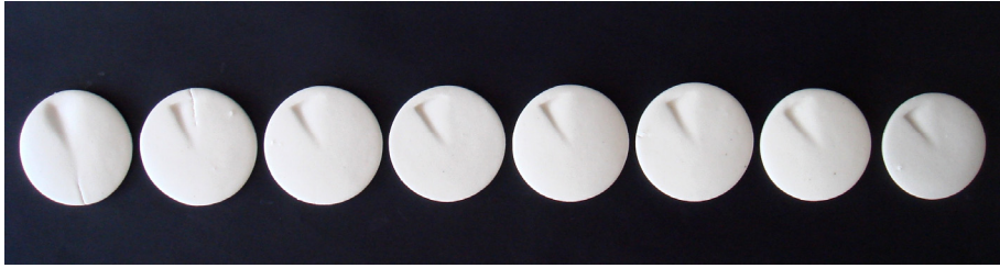
Resim 47: 45 no'lu sırnın 8 farklı bünyede uygulama sonuçları, soldan sağa: 1,2,3,4,5,6,7 no'lu bünyeler ve ESC 7Eczacıbaşı porselen bünye
