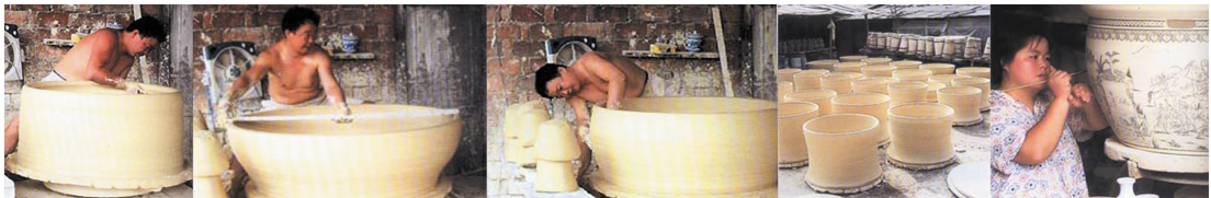
Resim 13. Tornada porseleni şekillendirme, kurutma ve dekorlama
