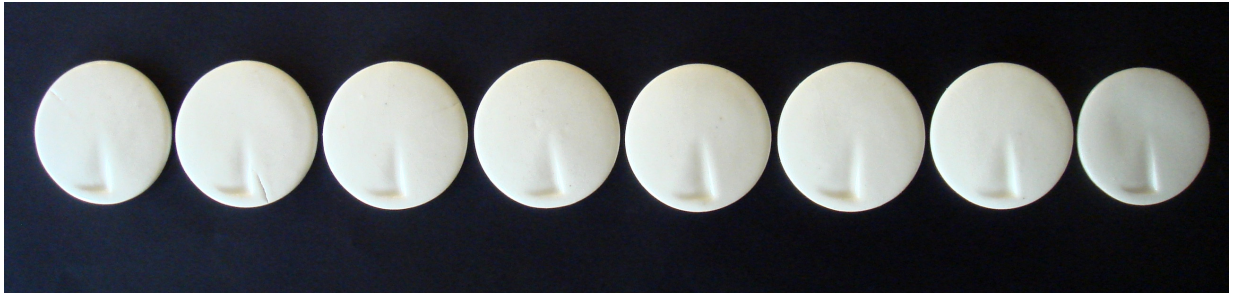
Resim 48: 49 no'lu sırnın 8 farklı bünyede uygulama sonuçları, soldan sağa: 1,2,3,4,5,6,7 no'lu bünyeler ve ESC 7Eczacıbaşı porselen bünye
