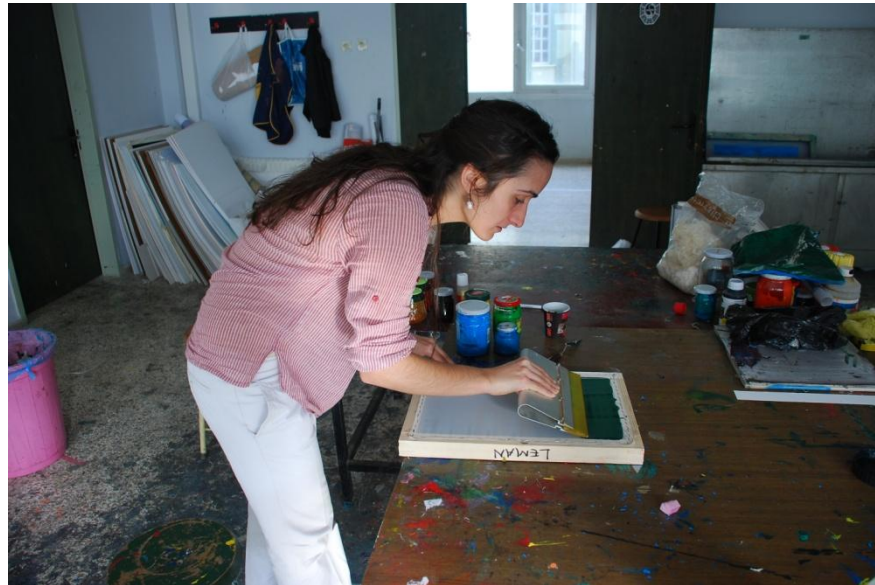
Resim 179: Emülsiyonun rakle ile çekilmesi.
