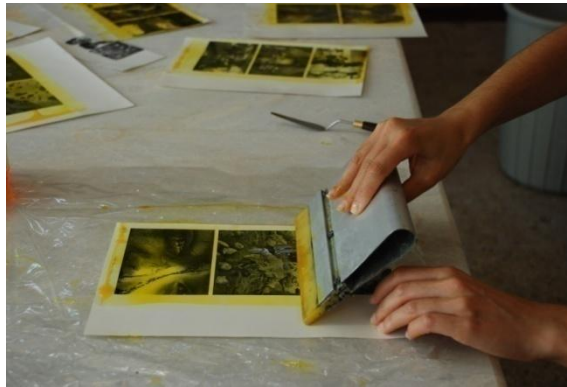
Resim 165: Lakın rakle ile çekilmesi.
