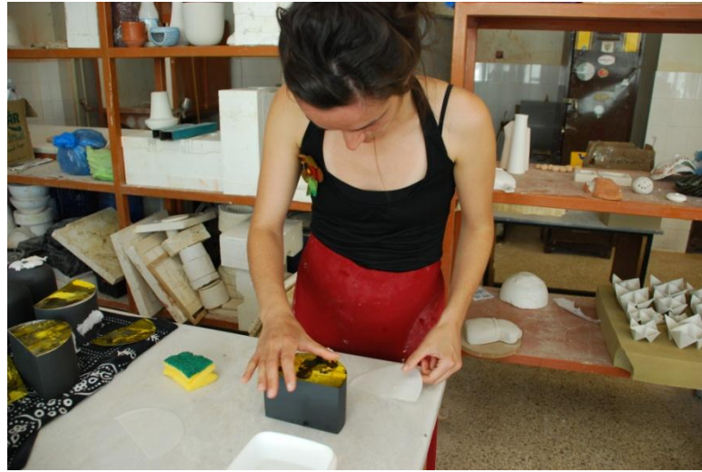
Resim 171: Oluşabilecek hava kabarcıkları ve su birikintilerinin uzaklaştırılarak yüzeyin düzeltilmesi.
