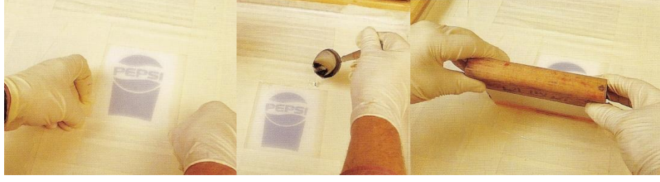
Resim 126: Boş eleğin lak çekilmesi için hazırlanması.
