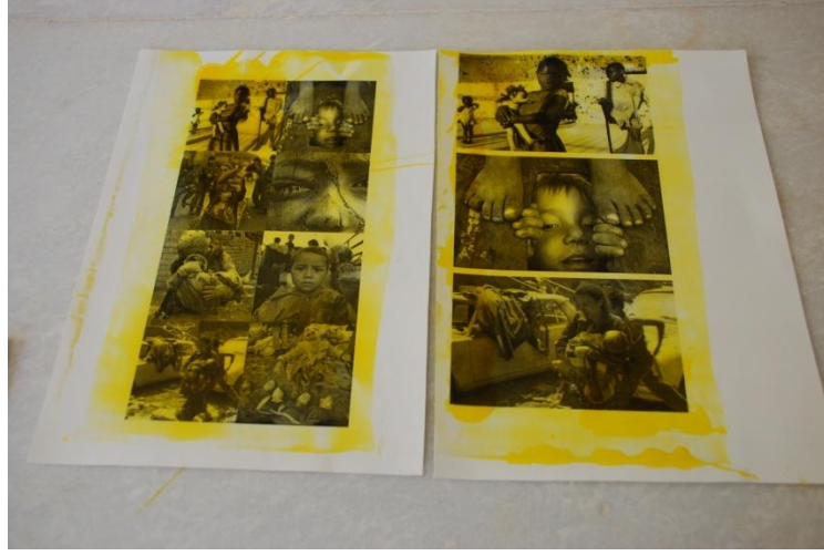
Resim 166: Lak çekme işleminden sonra dekallerin kurutulması.
