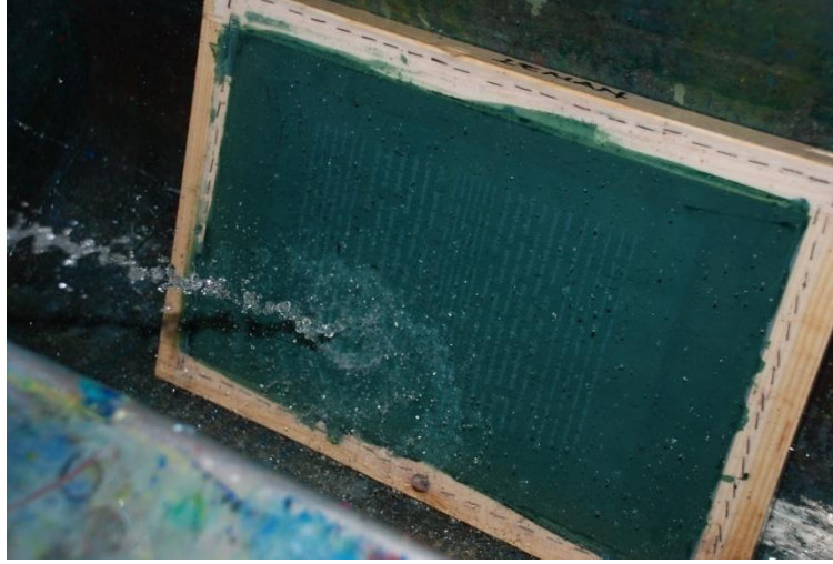
Resim 180: Eleğin pozlandırma sonrası yıkanması işlemi.
