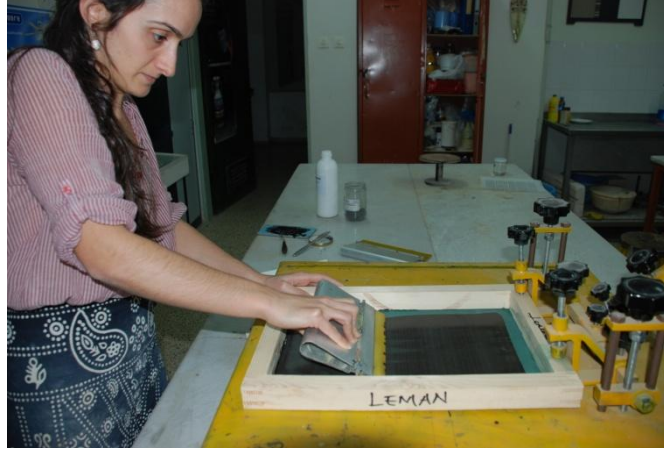
Resim 183: Boyanın rakle ile çekilmesi.
