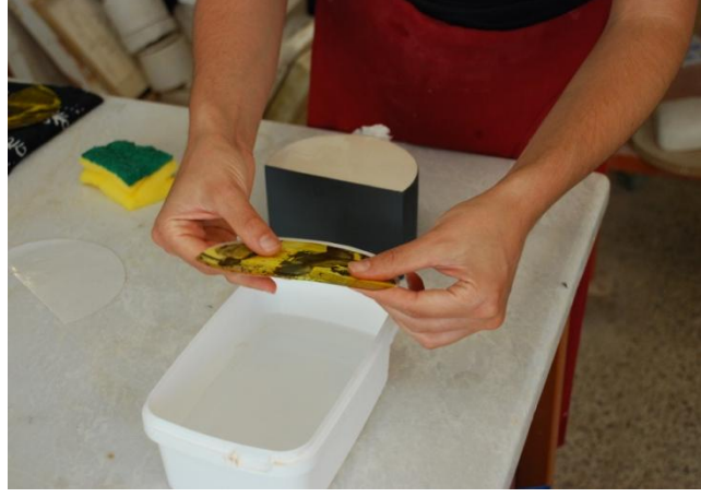
Resim 169: Laklı yüzeyin görüntüyle birlikte destek kâğıttan ayrılması.
