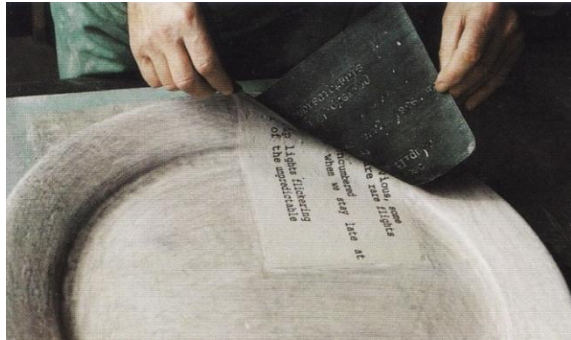
Resim 75: Patrick King, deri sertliğindeki çamur üzerinden transfer kâğıdının kaldırılması.
