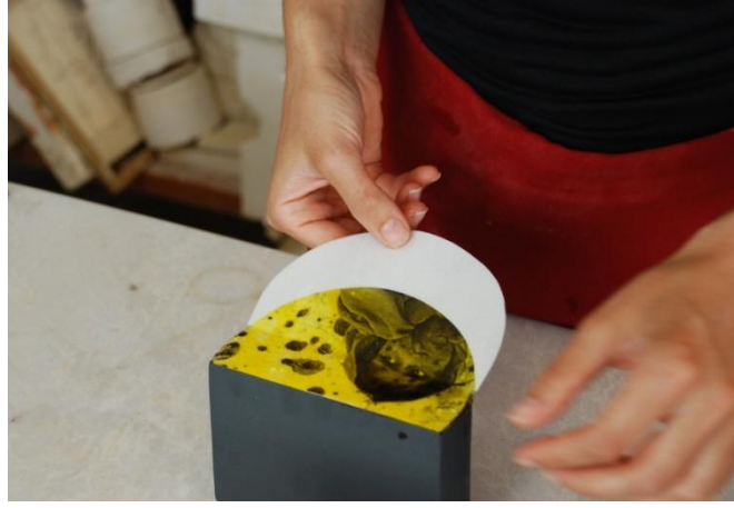
Resim 170: Dekalin sırlı seramik yüzeye aktarılması.
