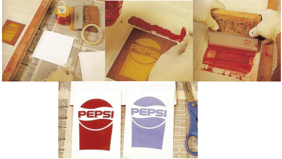
Resim 122: Dekal kâğıdın köşelenerek yerleştirilmesi.
