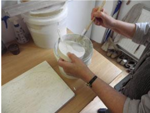
Resim 35-Fırça ile fazla çamur alınırken
