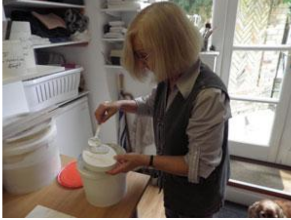
Resim 34-Alçı kalıbın üzerine kağıt porselen uygulaması
