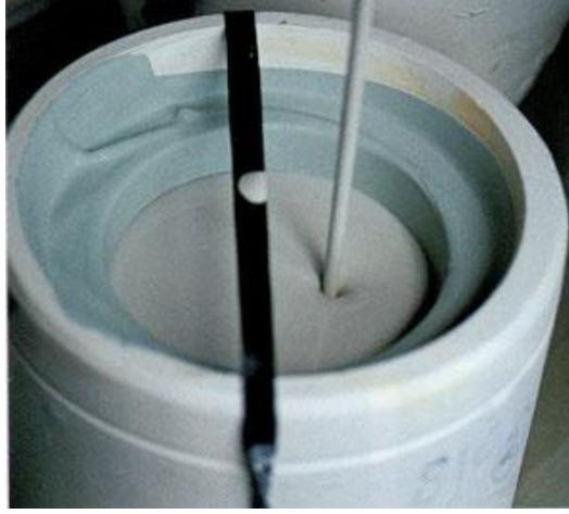
Resim 121-Renkli amurla katman katman döküm işleml
