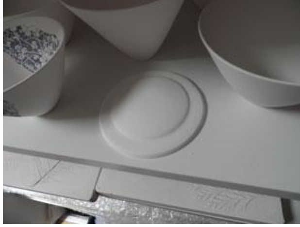
Resim 44-Mellor'ın Atölyesinde kullandığı seter(destek kalıp)
