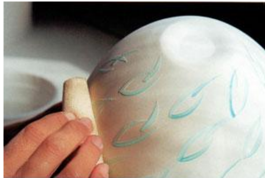
Resim 118-Sünger ile yüzey inceltme işlemi
