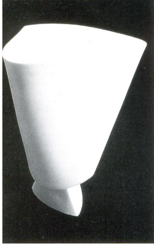
Resim 23- Setter Kullanılmadan Pişirilmiş Ürün
