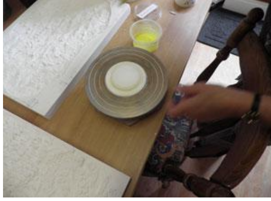
Resim 46-Alüminyum Oksit Uygulanmış Set(destek kalıp)
