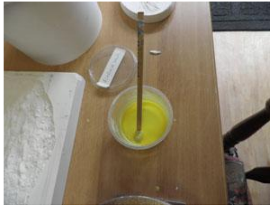
Resim 45-Gıda Boyası koyarak Sulandırdığı Alüminyum Oksit
