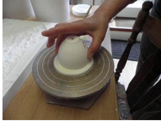
Resim 47-Setin(destek kalıp) üzerine pişirmek üzere ters olarak kapatılan kase
