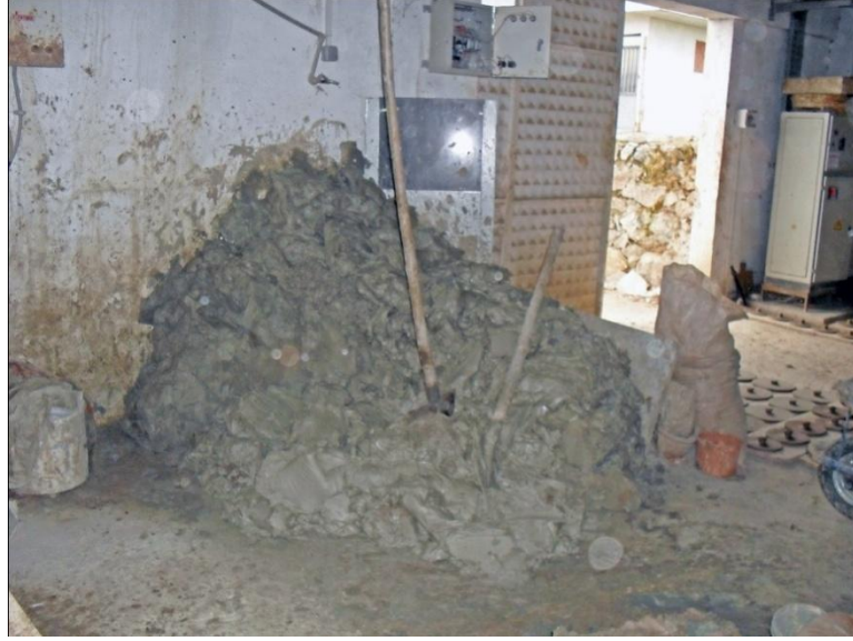
Fotoğraf 79: Vakum presten geçmeye hazır hale gelmiş çamur
