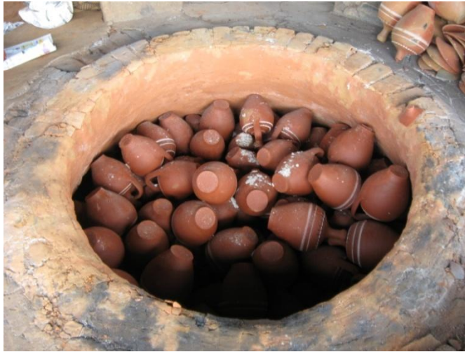
Fotoğraf 93: Pişirim için doldurulmuş fırın
