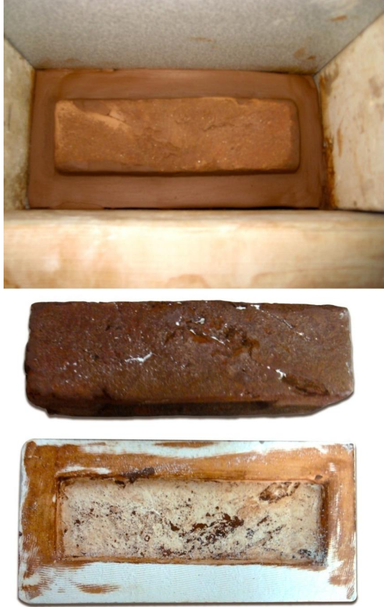
Fotoğraf 151: El üretimi olan harman tuğlanın alçı kalıp kurgusu ve alçı kalıbı
