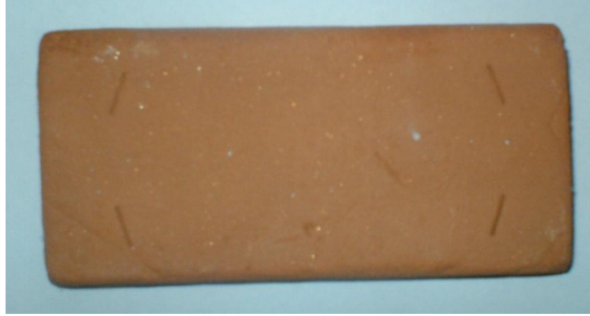
Fotoğraf 98: Kuru küçülme için işaretlenen çamur plaka
