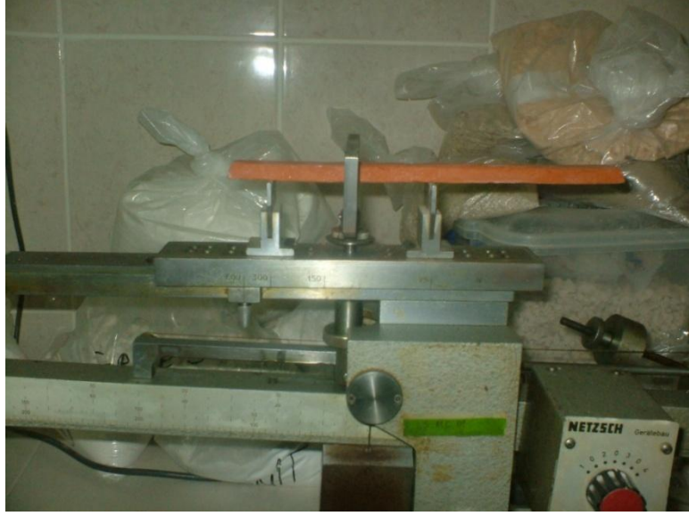
Fotoğraf 102: Mukavemet testinin uygulanışı
