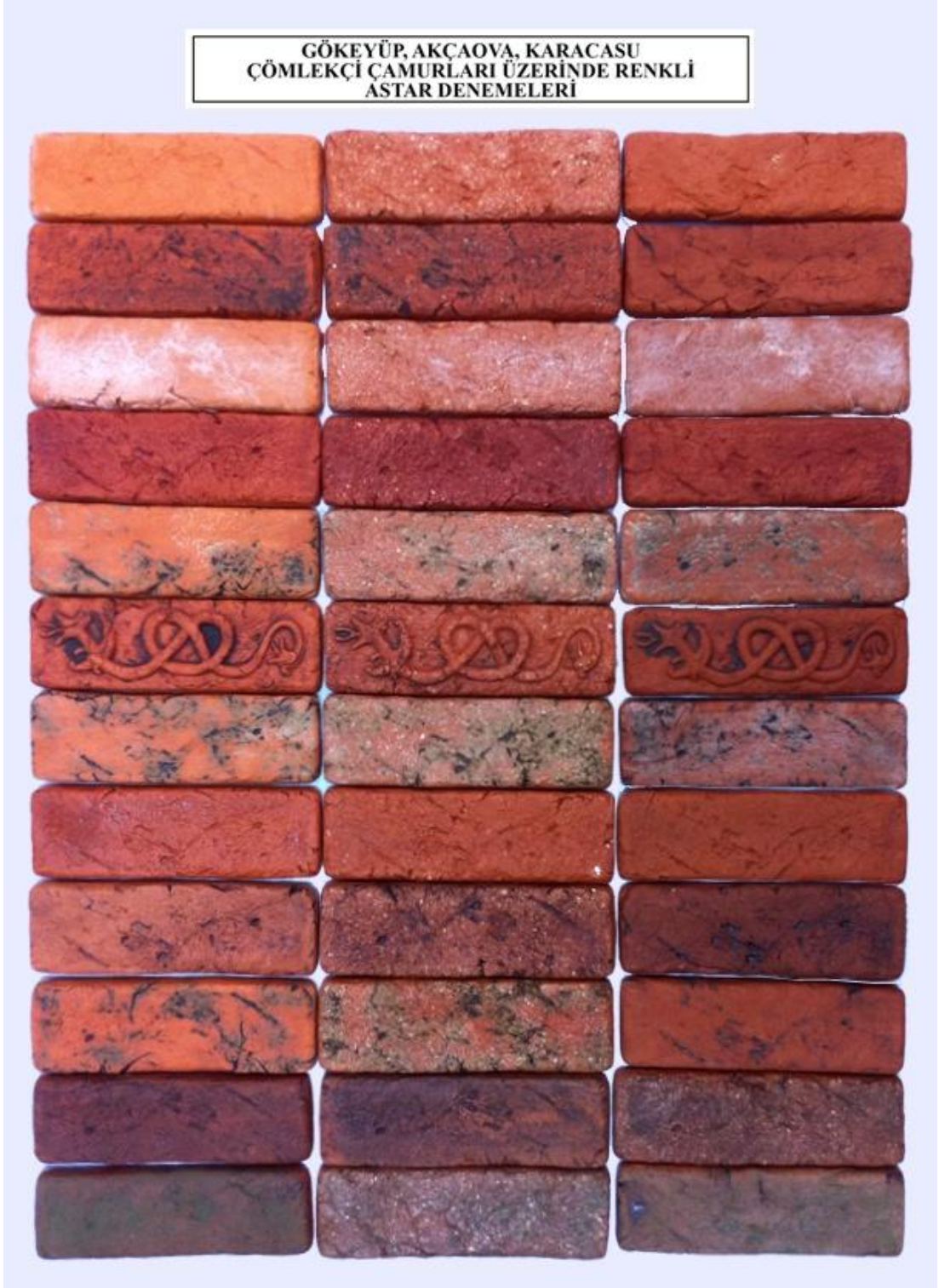
Fotoğraf 176: Gökeyüp, Karacasu, Akçaova çömlekçi çamurları üzerinde renkli astar denemeleri
