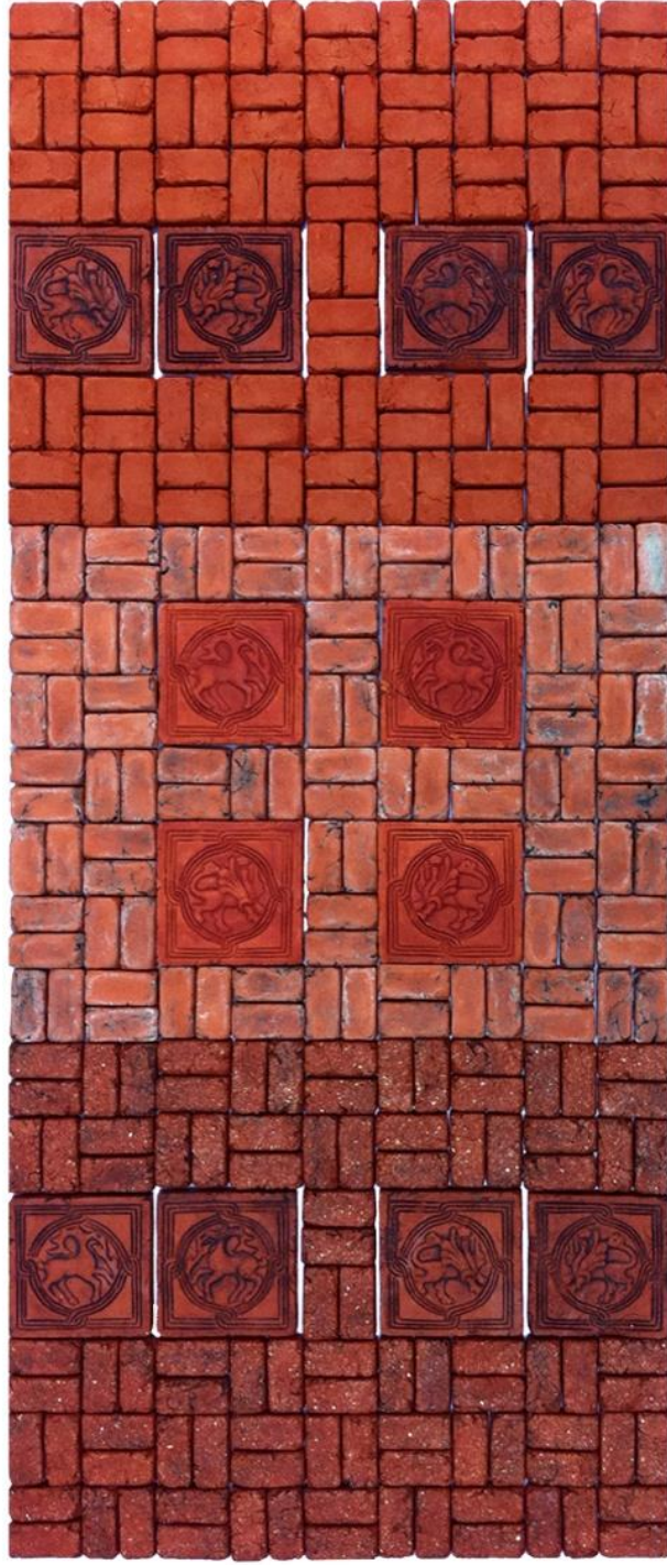
Fotoğraf 170: Yukarıdan aşağıya sırasıyla Karacasu, Akçaova, Gökeyüp çömlekçi çamuruyla dekoratif amaçlı üretilmiş ve bisküvi pişirimi yapılmış tuğlalar.
