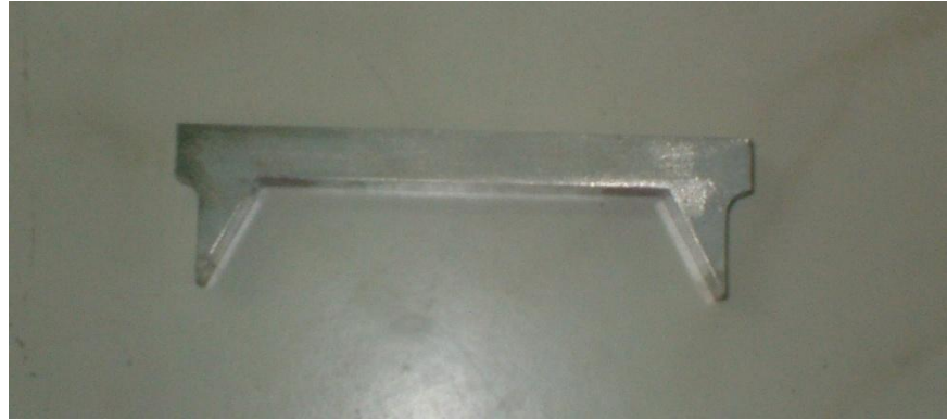
Fotoğraf 99: Kuru ve pişme küçülme testinde kullanılan metal ölçek
