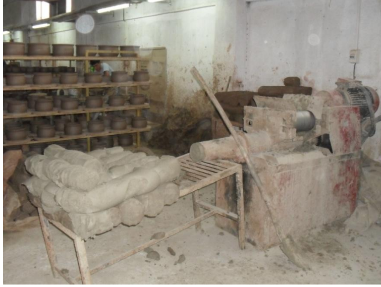
Fotograf 80: Vakum presten geçirilen tornada çekilmeye hazır çamur
