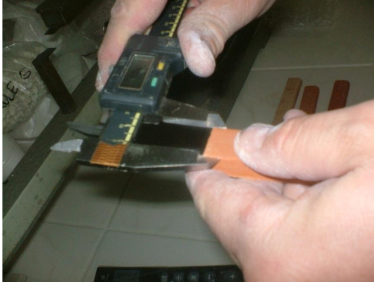
Fotoğraf 104: Mukavemet testinin deęerlerinin ölçülmesi
