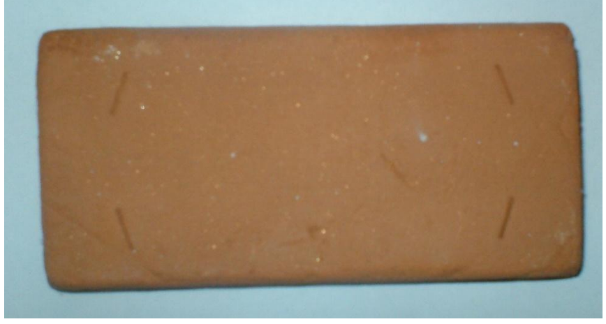
Fotoğraf 100: Pişme küçülme için işaretlenen çamur plaka
