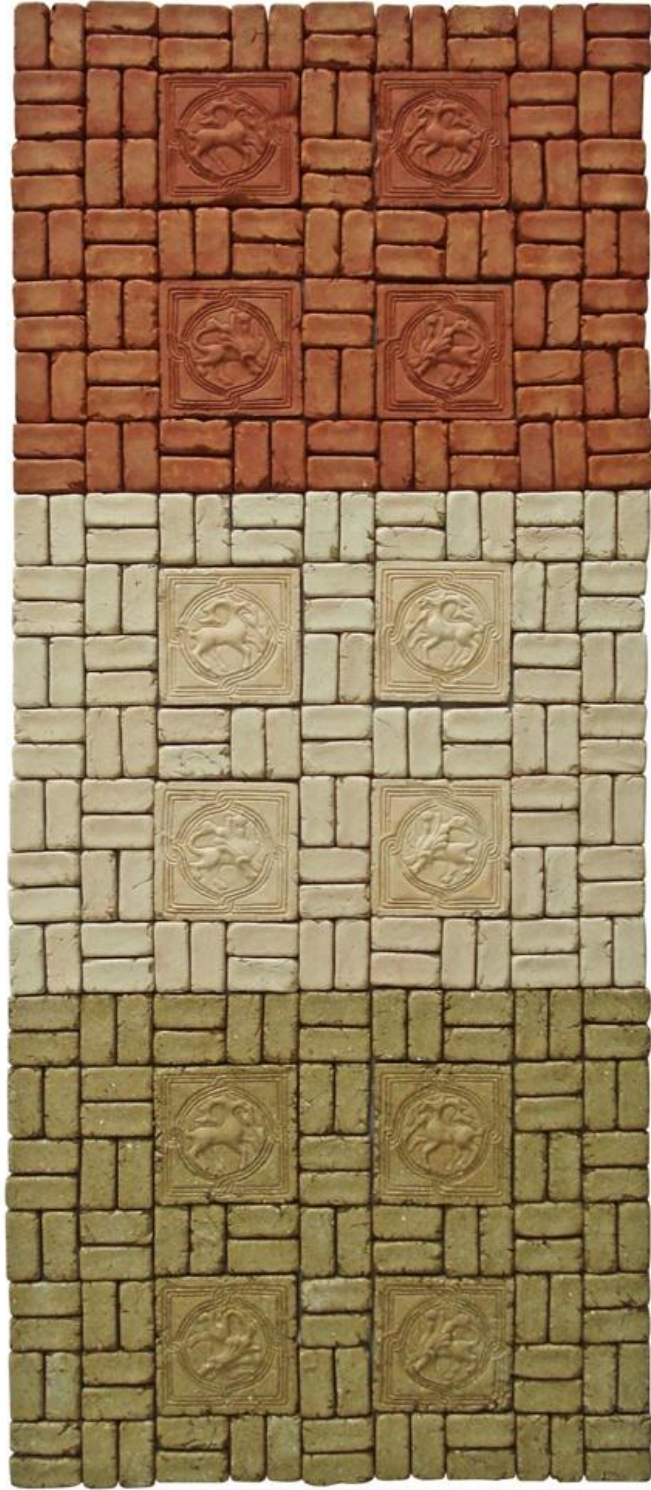
Fotoğraf 169: Yukarıdan aşağıya- Karacasu, Akçaova, Gökeyüp çömlekçi çamuruyla üretilmiş bisküvi pişirimi yapılmamış tuğlalar
