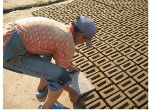
Fotoğraf 36: Kalıptan çıkarma
