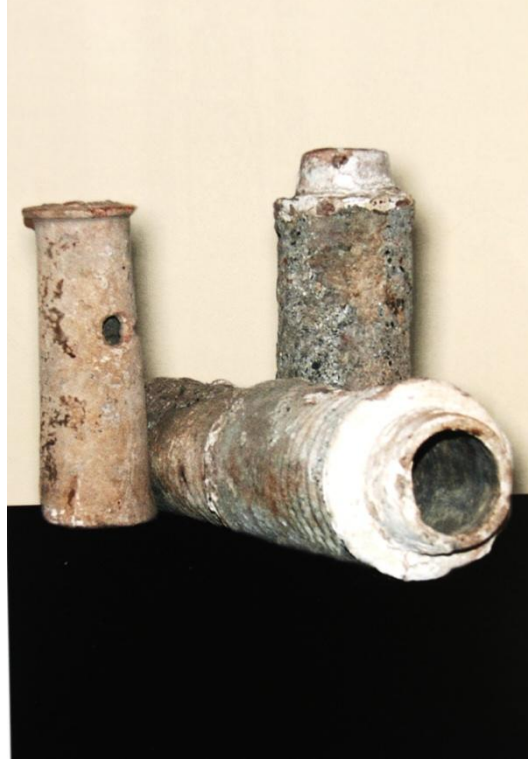
Fotoğraf 14: Temiz su tahliyesinde kullanılan pişmiş kırmızı toprak künkler
