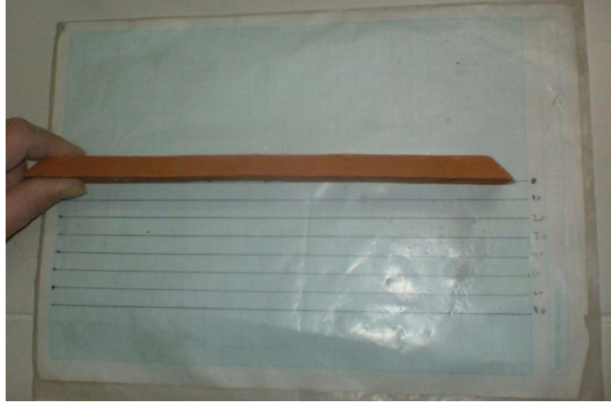
Fotoğraf 101: Deformasyon testinde kullanılan bisküvi pişirimi yapılmış plaka
