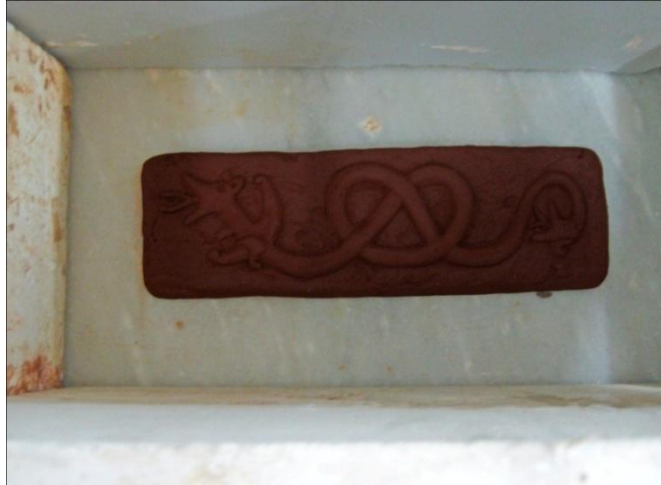
Fotoğraf 153: Hazırlanan model ve alçı kalıp kurgusu
