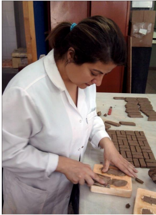
Fotoğraf 163: Alçı kalıba çamur basma işlemi
