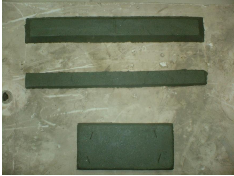
Fotoğraf 95: Testlerde kullanılan çamur plakaların şekilleri
