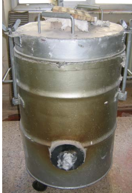
Resim 44: Düşük sıcaklıkta gelişen bakır kırmızısı sırlar için kullanılan, iç boyutları 40cm×65cm olan küçük gazlı fırın.
