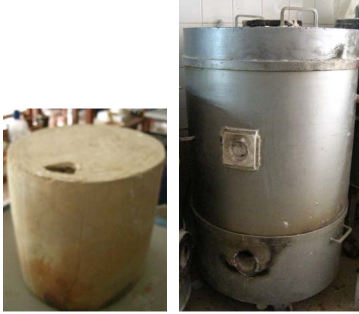
Resim 45: Düşük sıcaklıkta gelişen bakır kırmızısı sırlar için kullanılan, iç boyutları 53cm \times 93cm olan büyük gazlı fırın ve iç boyutları 40cm \times 40cm olan sagar kutusu.
