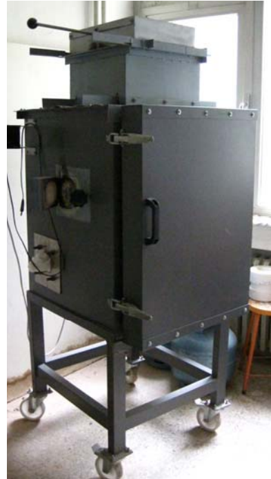
Resim 46: Yüksek sıcaklıkta gelişen bakır kırmızısı sırları elde etmek için yapılan iç boyutları 39cm×49cm×60cm olan gazlı fırın.
