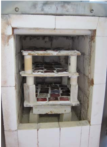
Resim 46: Yüksek sıcaklıkta gelişen bakır kırmızısı sırları elde etmek için yapılan iç boyutları 39cm×49cm×60cm olan gazlı fırın.
