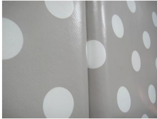
Resim-61: Gofraj görünümünden Kaynaklanan Hatalar
