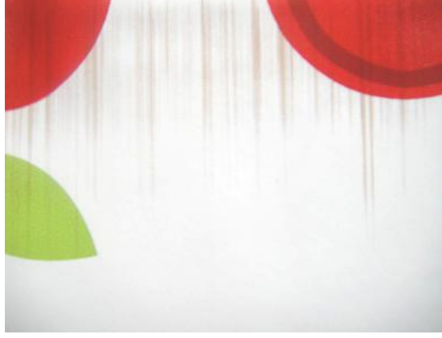
Resim-58: Sıyrımadan Kaynaklanan Hatalar Kaynak: Sanem Plastik Ltd.Şti.
