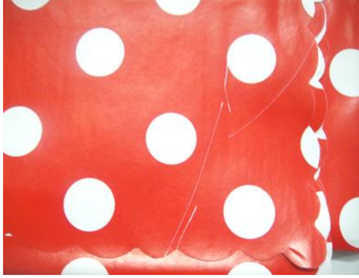
Resim-52: Bobin Çatlağından Kaynaklanan Hatalar Kaynak: Sanem Plastik Ltd.Şti.
