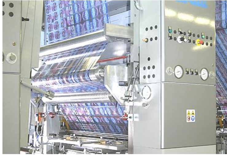
Resim-18: Cerutti marka 960 Model Rotagravür Silindiri- Baskı Aşaması Kaynak: http://www.cerutti.it/group/cerutti/r960_popup.html ,17.01.2011
