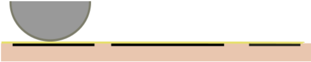
Resim-22: Malzemenin silindir üzerine konması ve ağır bir silindirle preslenmesi Kaynak: www.wikipedia.com, 05.05.2011
