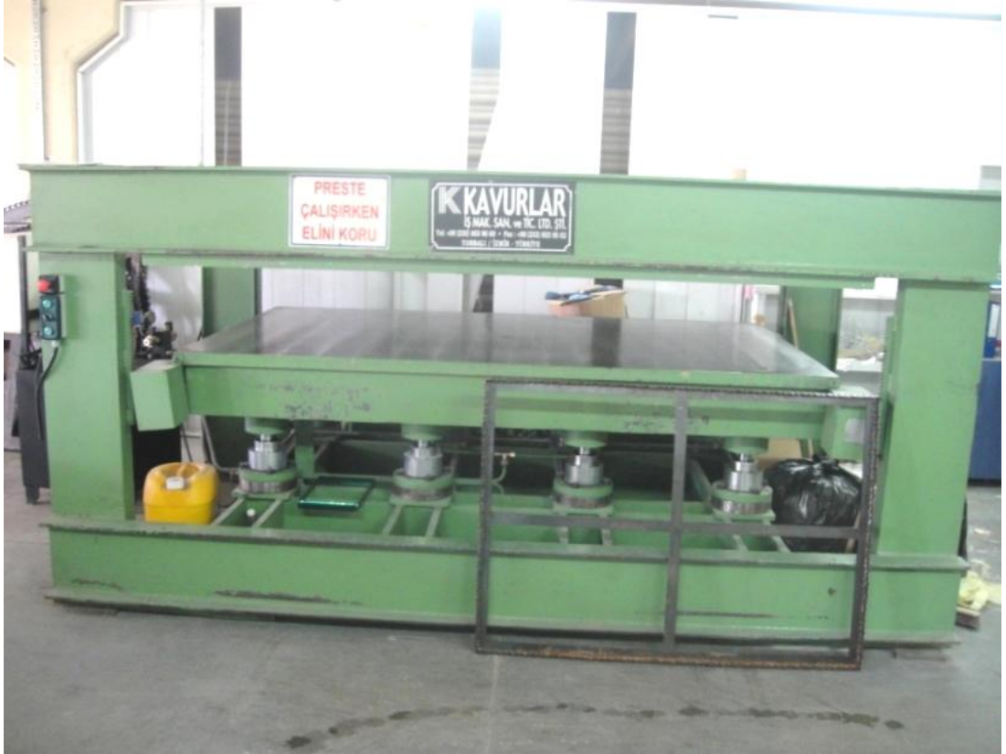
Resim-67: PVC Hazır Masa Örtüsü Kesim Makinesi Kaynak: Sanem Plastik Ltd.Şti.
