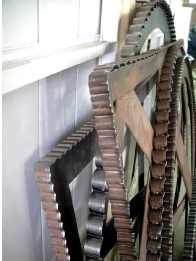
Resim-69: PVC Hazır Masa Örtüsü Kesim Kalıpları Yandan Görünüm Kaynak: Sanem Plastik Ltd.Şti.
