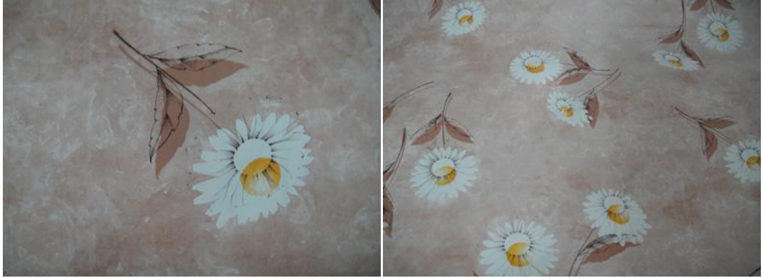
Resim-59: Kaymadan Kaynaklanan Hatalar Kaynak: Sanem Plastik Ltd.Şti.
