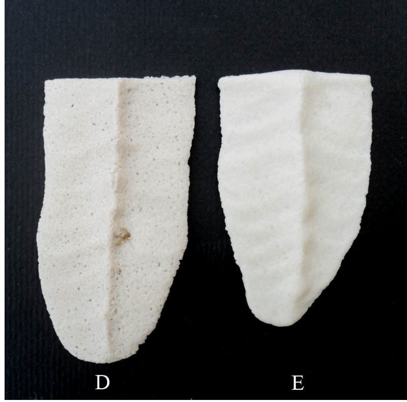
Resim 55 – Kuvars ve cam tozu ilaveli vakum çamuru, 1150 °C
