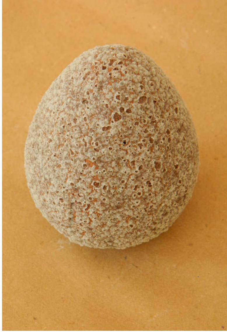
Resim 63 – Cam tozunun kırmızı çamurdaki etkisi, 1050 °C
