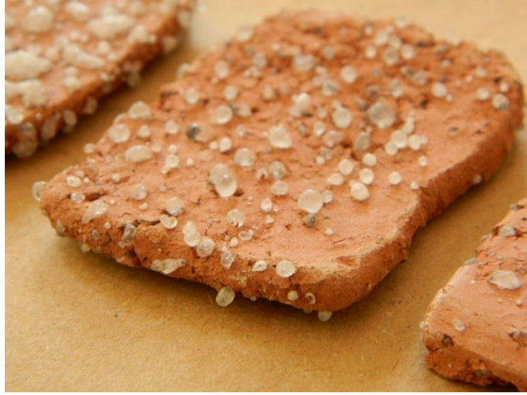
Resim 61 – Cam parçalarının kırmızı çamurdaki etkisi
