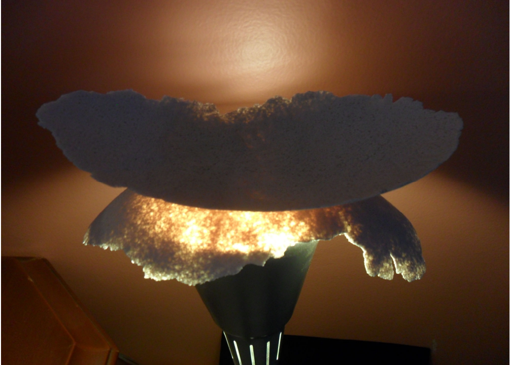
Resim 57 / 58 – Kuvars ve cam tozu ilaveli vakum çamuru, 1150 °C
