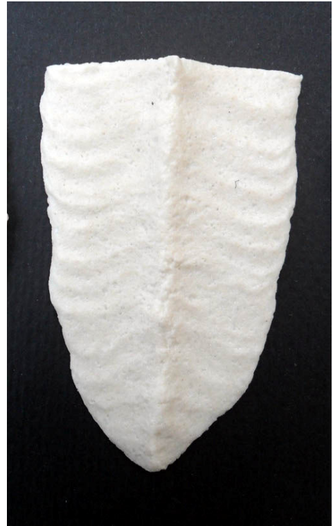
Resim 47 / 48 – Porselene en yakın fritli vakum çamurunun ışık geçirgenliği 1200°C
