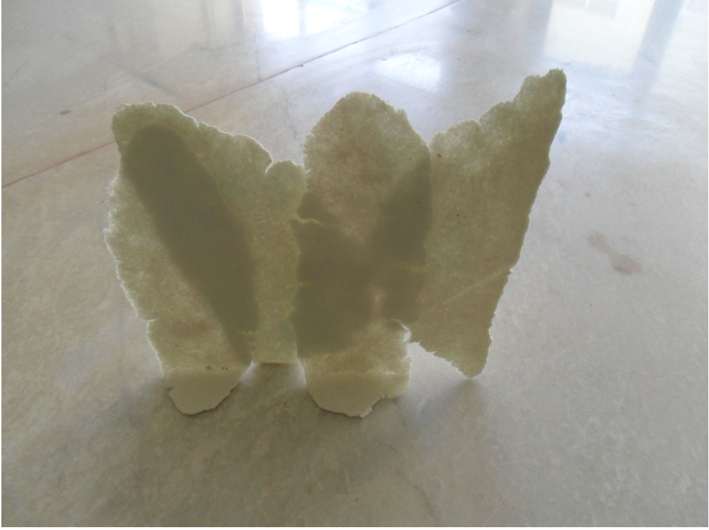
Resim 57 / 58 – Kuvars ve cam tozu ilaveli vakum çamuru, 1150 °C
