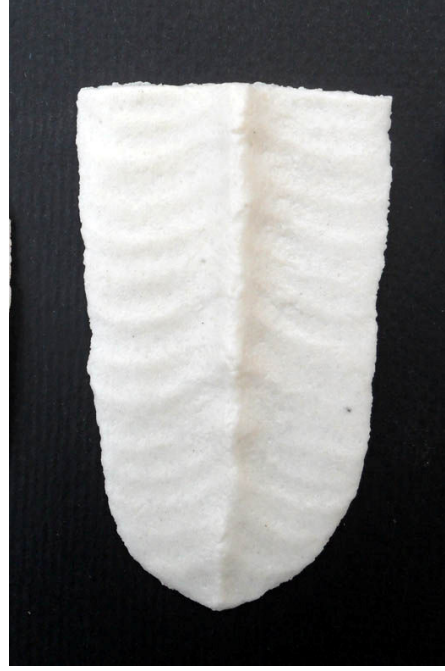
Resim 53 / 54 – %10 Kuvars katkılı, fritli vakum çamuru, 1200 °C
