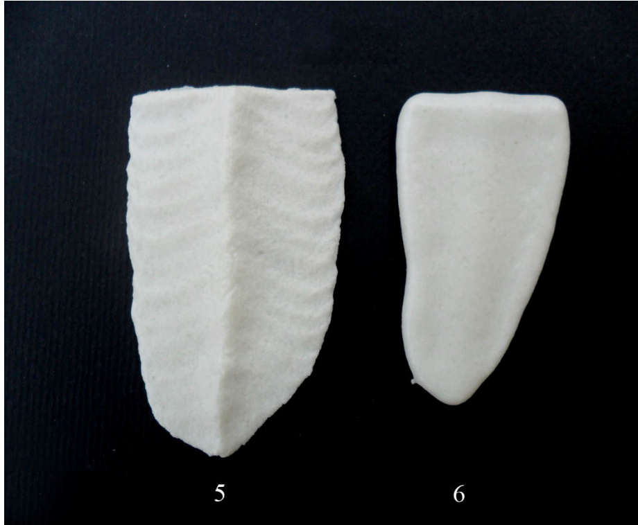
Resim 49 – 1150 °C de pişirilen cam tozu katkılı vakum çamuru
