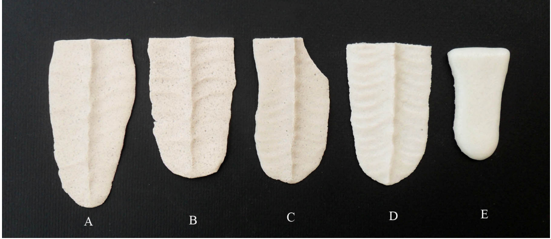
Resim 51 – %10 kuvars katkılı, fritli vakum çamuru
