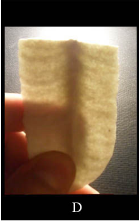
Resim 53 / 54 – %10 Kuvars katkılı, fritli vakum çamuru, 1200 °C
