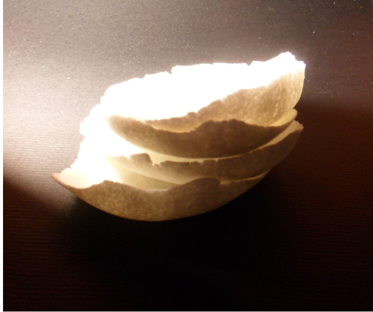
Resim 59 / 60 – Kuvars ve cam tozu ilaveli vakum çamuru, 1150 °C
