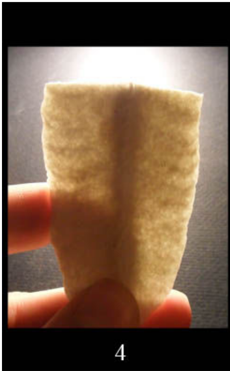
Resim 47 / 48 – Porselene en yakın fritli vakum çamurunun ışık geçirgenliği 1200°C
