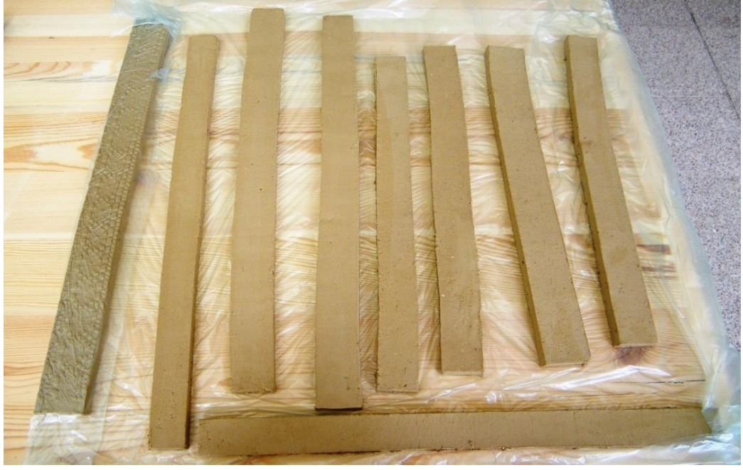
Resim 81 : Açılmış olan plakadan belirlenmiş olan ölçülerde şeritlerin kesilmesi
