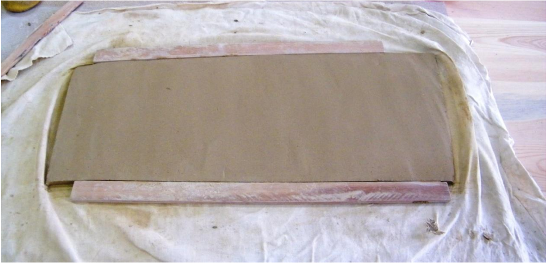
Resim 80 : Şamotlu çamur ile plaka açılması.
