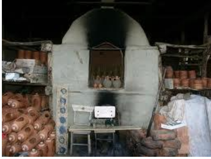
Resim 10 - Odun yakıtlı üstten çekişli çömlek fırını, Kınık Köyü, Türkiye
