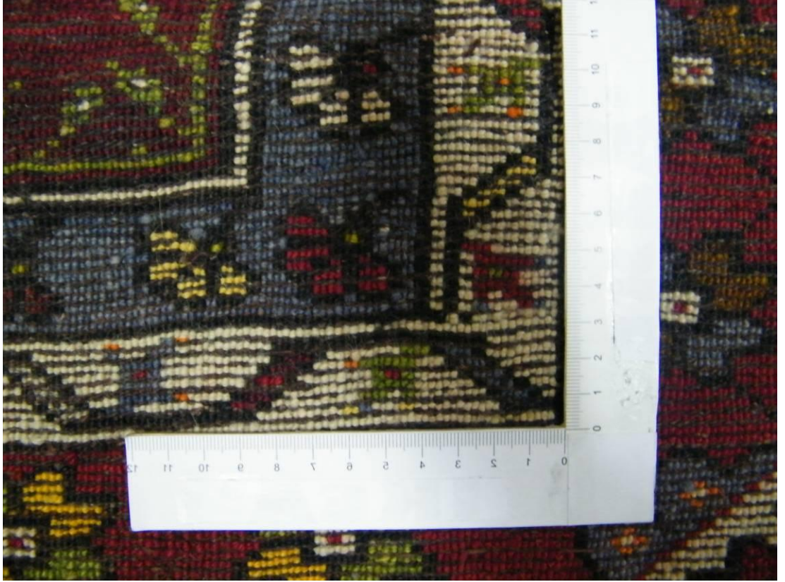
Fotoğraf 50 1578 envanter numaralı Küçük Muhsine halısının arka yüzünde 10x10 cm 2 lik cetvelle yapılan düğüm sıklığı analiz çalışması
