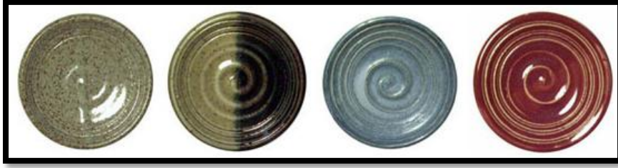
Fotoğraf 68: Ravenscrag Sır Görünümlü Astarları; (Soldan Sağa) Benekli Stoneware Üzerinde Saf Malzeme, 1300°C % 5 ve % 10 Demir Oksit İlavesi, 1300°C Frit Ve Kobalt Oksit İlavesi, 1200°C Frit, Krom Ve Kalay İlavesi
