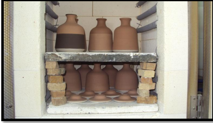
Fotoğraf 82: Pişirim Öncesi Formların Fırına İstiflenmesi Fotoğraf: Ayşe Madenoğlu Çalık
