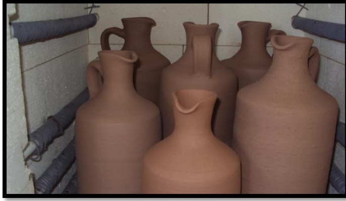
Fotoğraf 79: Formların Fırna İstiflenmesi Fotoğraf: Ayşe Madenoğlu Çalık
