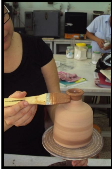
Fotoğraf 81: Astarların Forma Fırça ile Tornada Uygulanması Fotoğraf: Ayşe Madenoğlu Çalık
