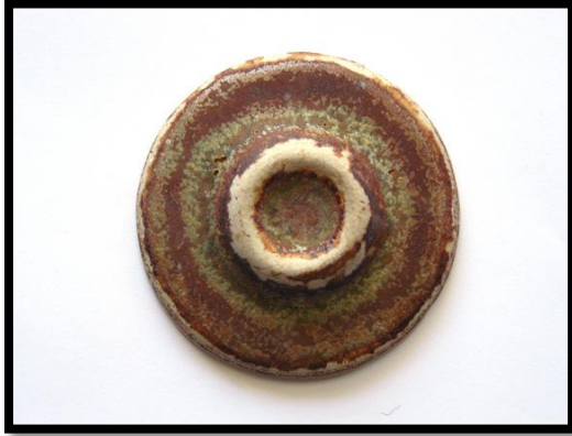
Fotoğraf 127: 30R Numaralı Sır Görünümlü Astarı Deneme Plakası, 1240°C'deki Fotoğrafi Fotoğraf: Kerem İldeş
