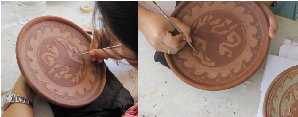
Resim 71: Deri Sertliğine Gelen Tabakların Dekorlanması
