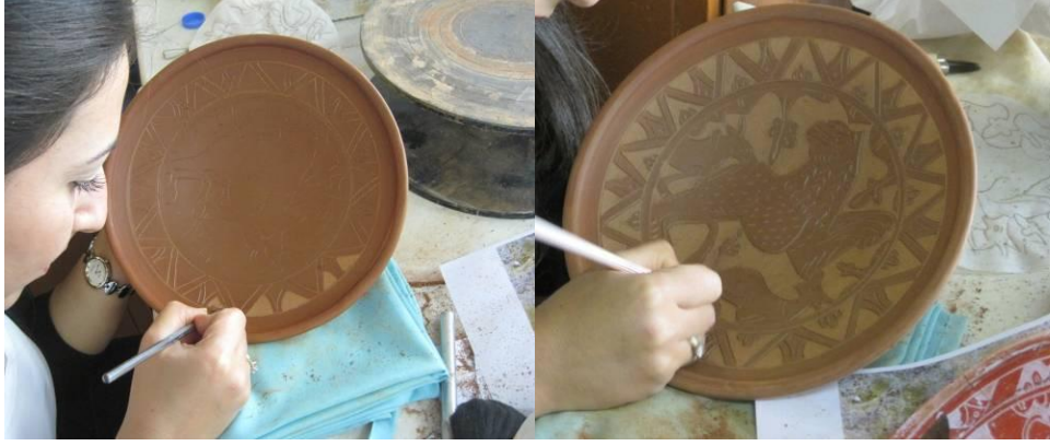
Resim 70: Deri Sertliğine Gelen Tabakların Dekorlanması
