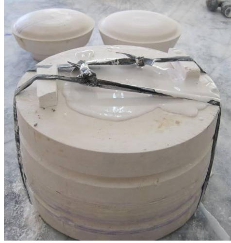
Resim 61: Dış Sıvama Kalıplarının Çoğaltılması
