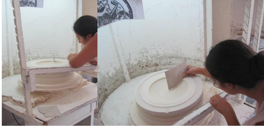
Resim 58: Kalıp Şekillendirme Aşamaları
