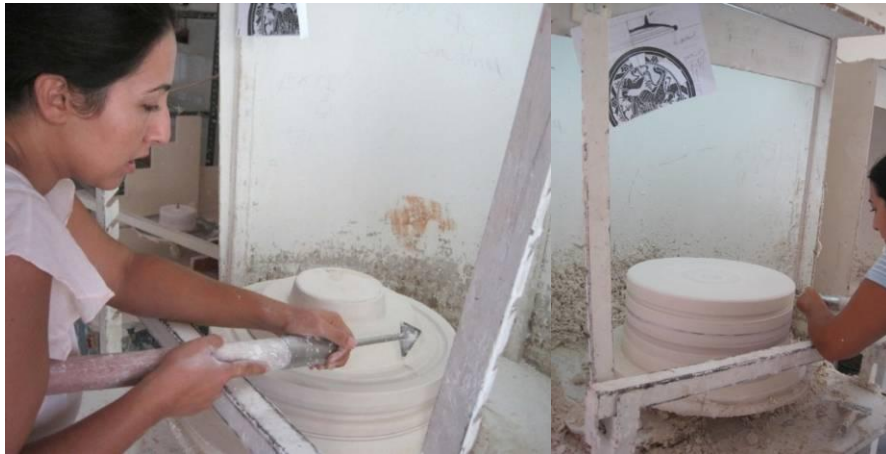
Resim 59: Kalıp Şekillendirme Aşamaları
