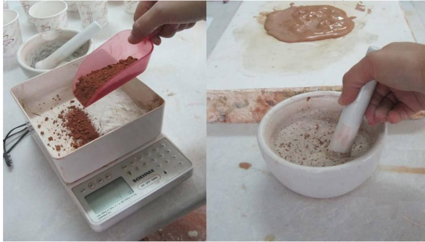
Resim 35: Bünye Denemelerinin Hazırlama Aşamaları
