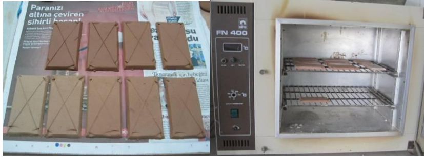
Resim 37: Bünye Denemelerinin Kurutma Aşamaları
