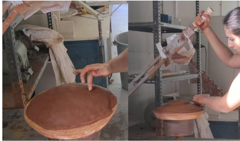
Resim 66: Şablon Tornada Şekillendirin Tabak
