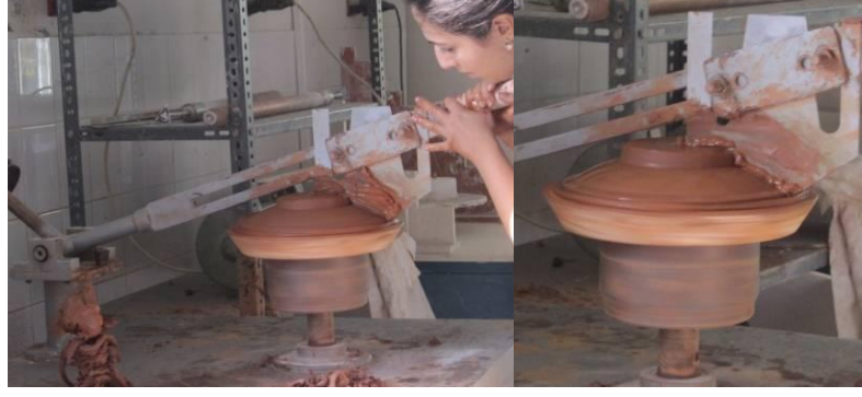
Resim 67: Şablon Tornada Şekillendirilen Tabak
