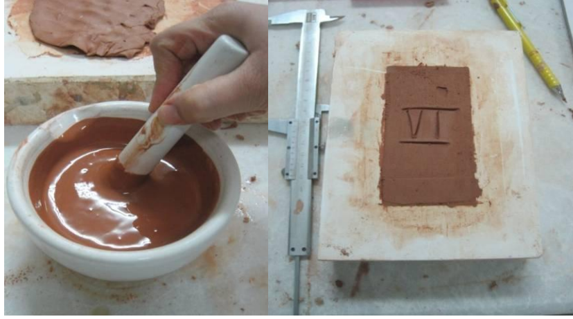
Resim 36: Bünye Denemelerinin Hazırlama Aşamaları
