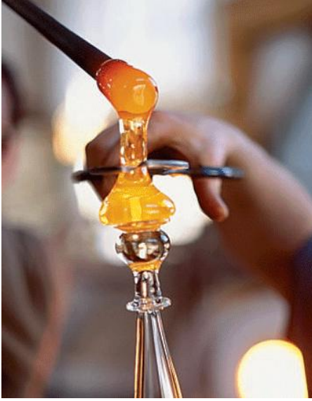
Resim 22: Aletler yardımı ile şekillendirme
