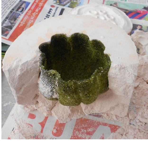
Fırlnlama sonrası kalıbın aılması. (Fotoğraf: Naciye Daniş)
