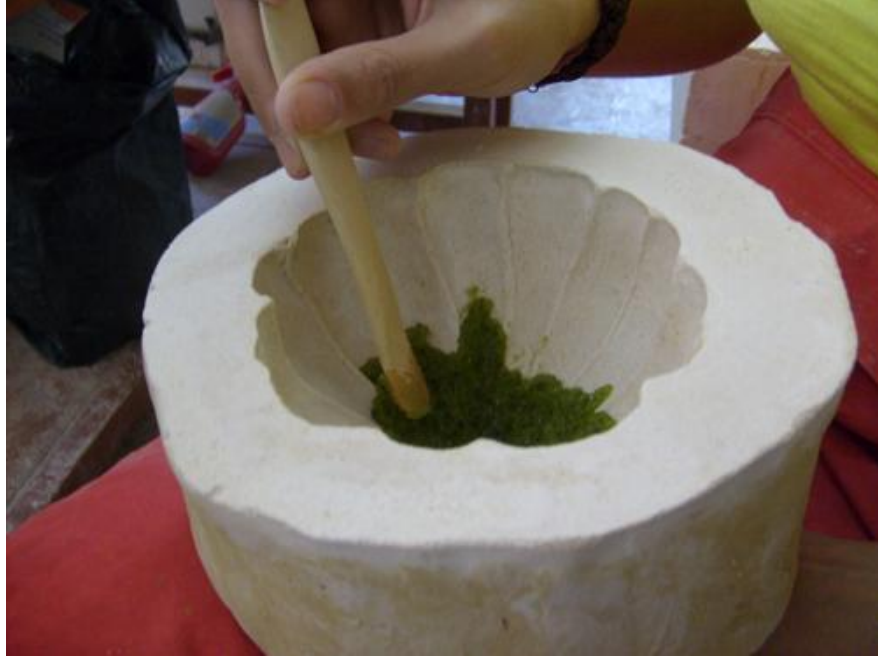
Cam parçacıklarının açık kalıba yerleştirilmesi. (Fotoğraf: Aslı Şalbaş)
