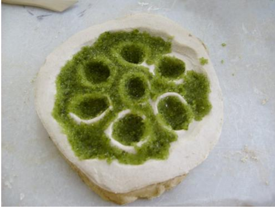
Cam parçacıklarının açık kalıba yerleştirilmesi. (Fotoğraf: Naciye Danış)
