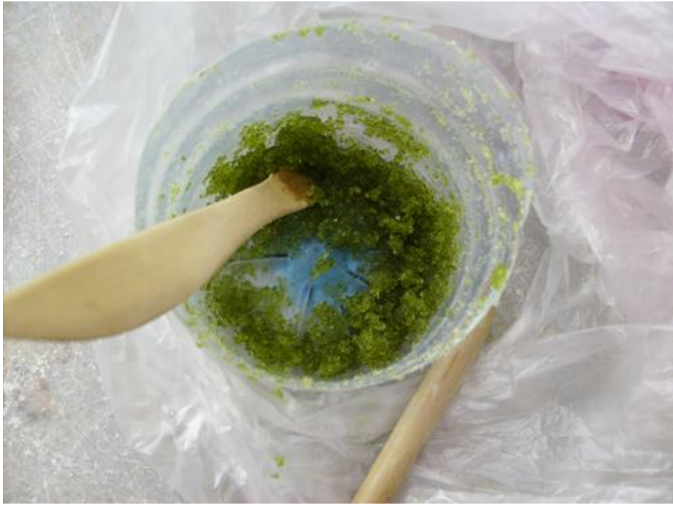
Duvar kağıdı yapıştırıcısı, su ve camın karıştırılması ile cam hamurunun hazırlanması. (Fotoğraf: Naciye Danış)
