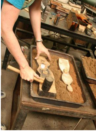
Resim 25: Kuma Döküm Tekniđi aşamaları
