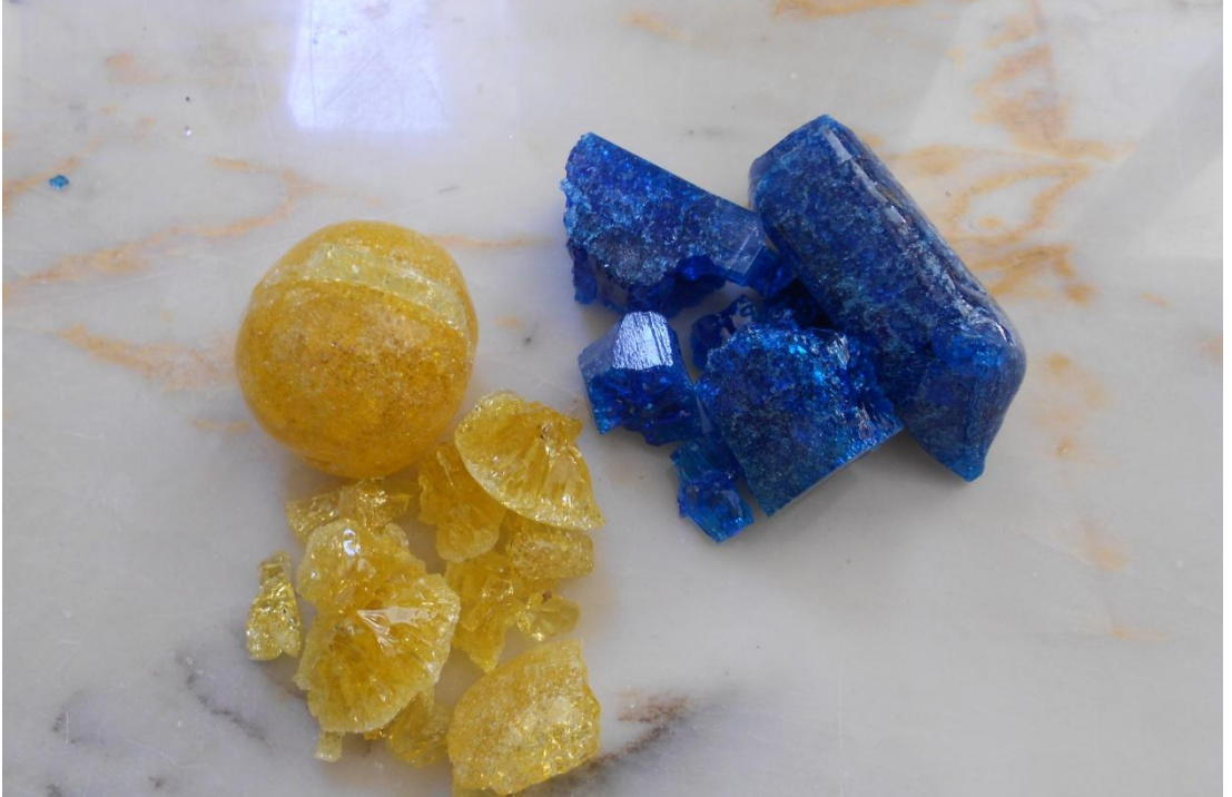
Camların termal şokla kırılması ve parçacık boylarının küçültülmesi. (Fotoğraf: Naciye Danış)
