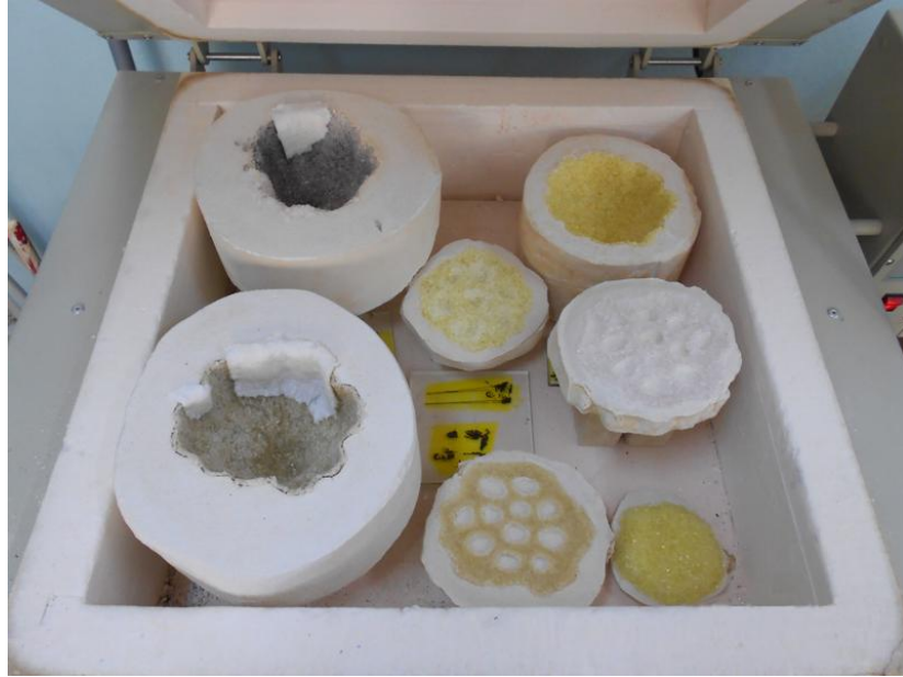
İşlemleri tamamlanmış kalıpların fırına yerleştirilmesi.(Fotoğraf: Naciye Danış)
