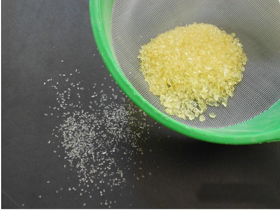
Cam parçacıklarının farklı tane boylarına ayrılması için elekten elenmesi. (Fotoğraf: Naciye Danış)
