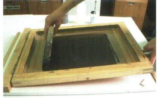
Resim 31 : Mürekkep eleğin ön kısmı boyunca eklenmesi.
