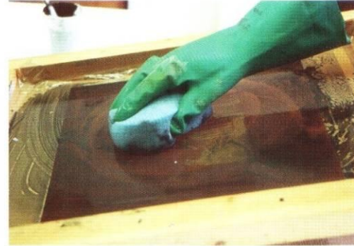
Resim 35 : Elekte kalan fazla mürekkebin temizlenmesi.
