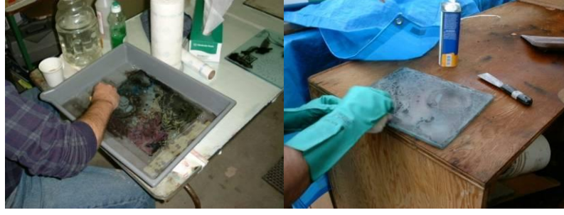
Resim 109 : Bir hazne içinde boyaların yüzeyden temizlenme işlemi.
