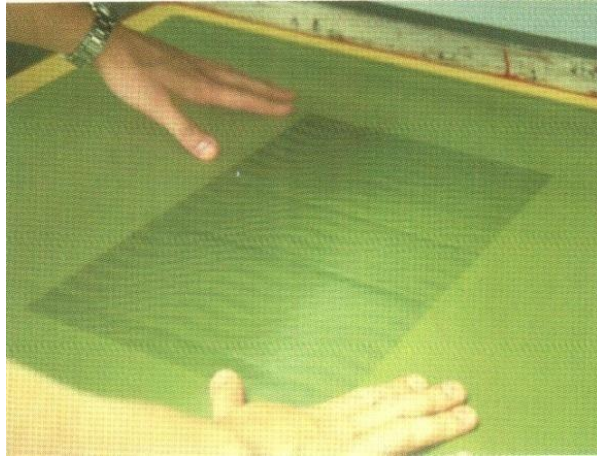
Resim 26 : Elek üzerine görüntünün yerleştirilmesi.
