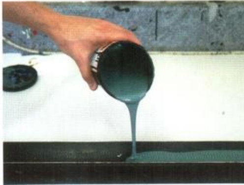
Resim 24 : Emülsiyonun elek üzerine dökülmesi
