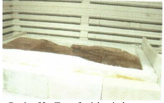
Resim 53 : Transfer işleminden sonra camın kalıba yerleştirilip 850C tekrar fırınlanma işleminin yapılması.
