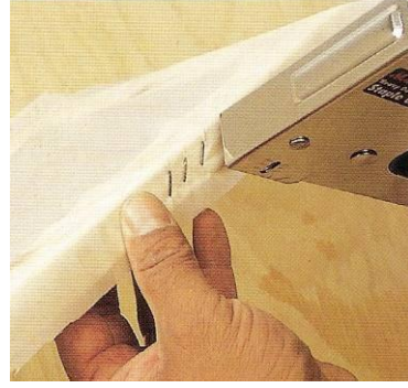
Resim 22 : İpeğin zımba tabancası ile çerçeveye montajı.
