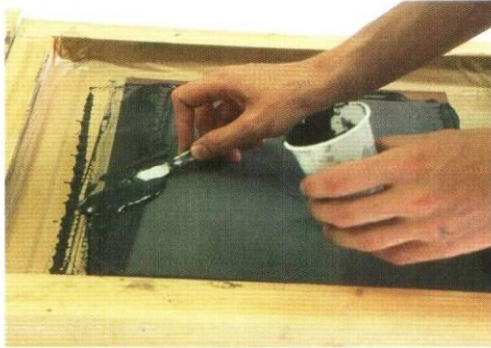
Resim 35 : Elekte kalan fazla mürekkebin temizlenmesi.
