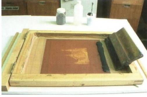
Resim 31 : Mürekkep eleğin ön kısmı boyunca eklenmesi.
