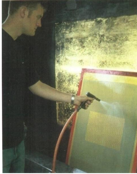
Resim 28 : Pozlandırma işleminden sonra eleğin durulanması.
