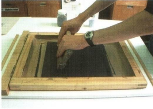
Resim 33 : Mürekkebin elekten cam yüzeyine geçirilmesi.
