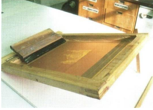
Resim 29 : Mürekkebin bir uçtan diğer uca çekilmesi.
