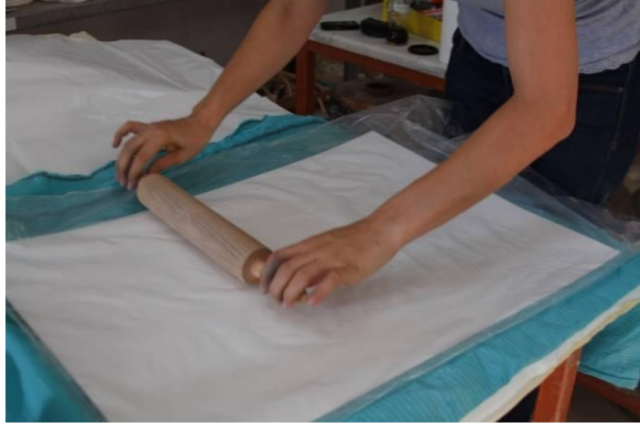
Resim 142 : Boyalı cam yüzey ile kağıdın yüz yüze getirilip baskı uygulanması işlemi.
