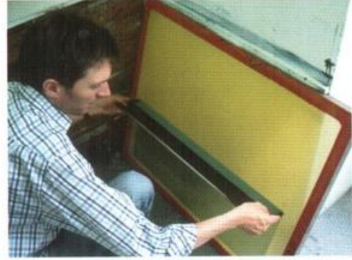
Resim 24 : Emülsiyonun elek üzerine dökülmesi
