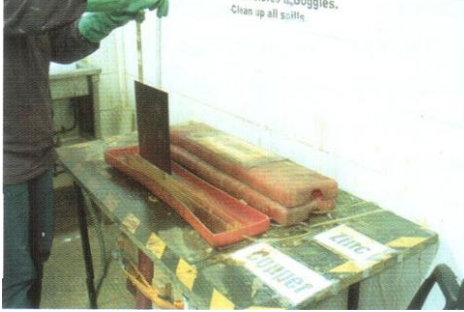
Resim 74 : Plakanın asid içerisine yerleştirilmesi işlemi.
