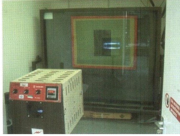
Resim 27 : Eleğin pozlandırma işleminin yapılması.
