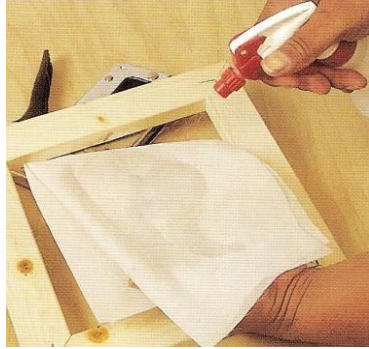
Resim 20 : İpeğin gergin bir şekilde montajı için ıslatılması.
