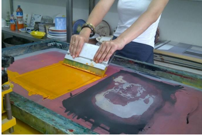
Resim 124 : Boyanın rakle ile çekilmesi.
