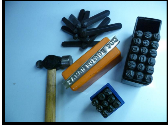
Resim 79. Harf ve rakam zımbaları. (Alparslan Kazaklı, orj. 2012)
