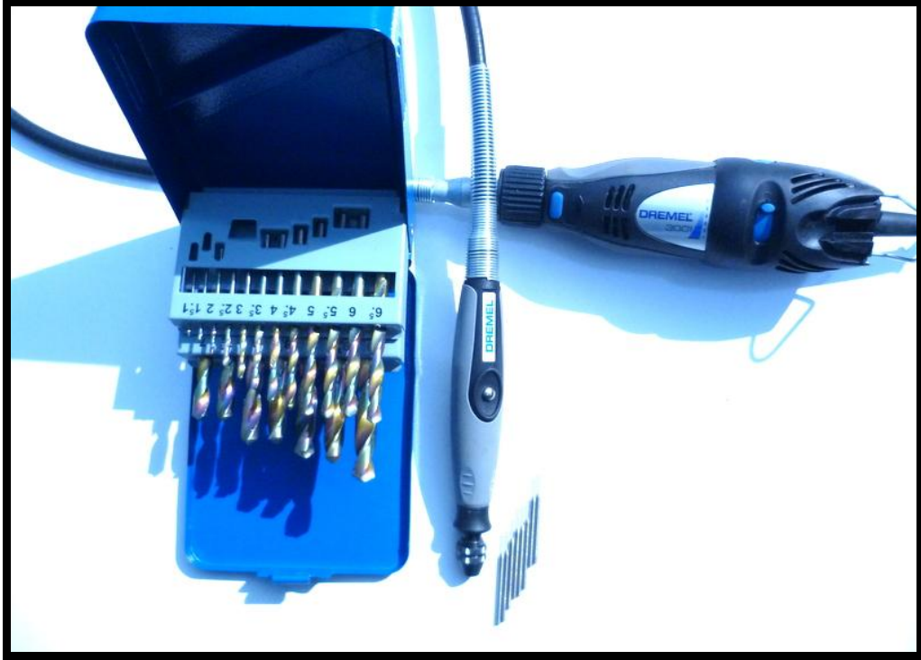
Resim 77 Freze ve çeşitli kalınlıklarda helezonik delme uçları. (Alparslan Kazaklı, orj. 2012)
