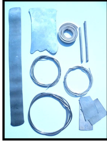
Resim 68. Gümüş plaka, boru şerit ve tel örnekleri. (Alparslan Kazaklı, orj. 2012)
