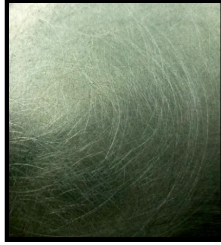
Resim 87. Dairesel zımpara doku görüntüsü (Alparslan Kazaklı, orj. 2012)
