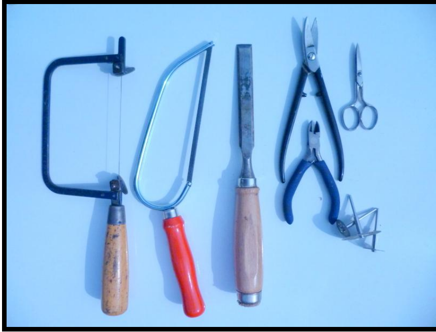
Resim 74. Kıl testere, demir testeresi, keski, yan keski, kıvrık makas ve freze ucuna takılan elmas kesim uçları (Alparslan Kazaklı, orj. 2012)
