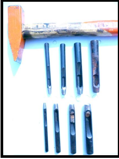
Resim 78. Farklı kalınlıklarda delik zımbaları. (Alparslan Kazaklı, orj. 2012)
