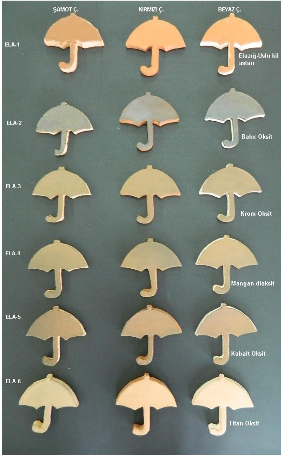
Resim 48: Elazığ- Uslu Kili ile hazırlanan astarın Metal oksitlerle renklendirilmesi
