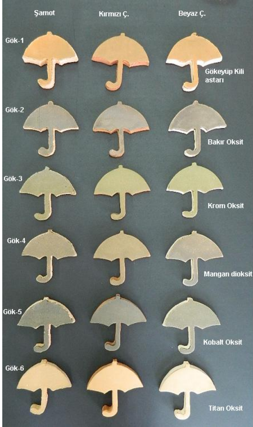
Resim 52: Gökeyüp Kil astarının metal oksitlerle renklendirilmesi
