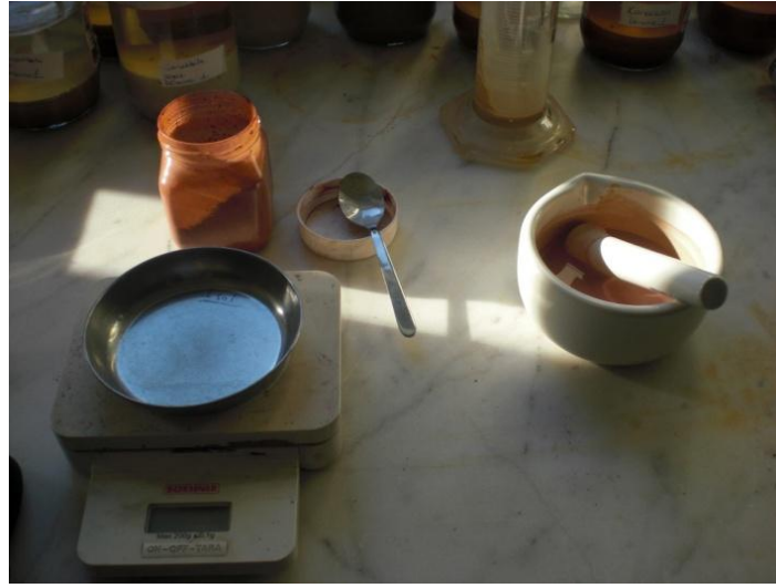
Resim 23: Renklendiricilerin tartımı ve Havan içinde öğütülmesi
