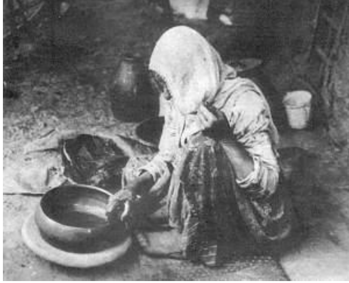
Resim13: Biçimlendirme sırasında kalıbın ayak başparmğıyla döndürülüşü.
