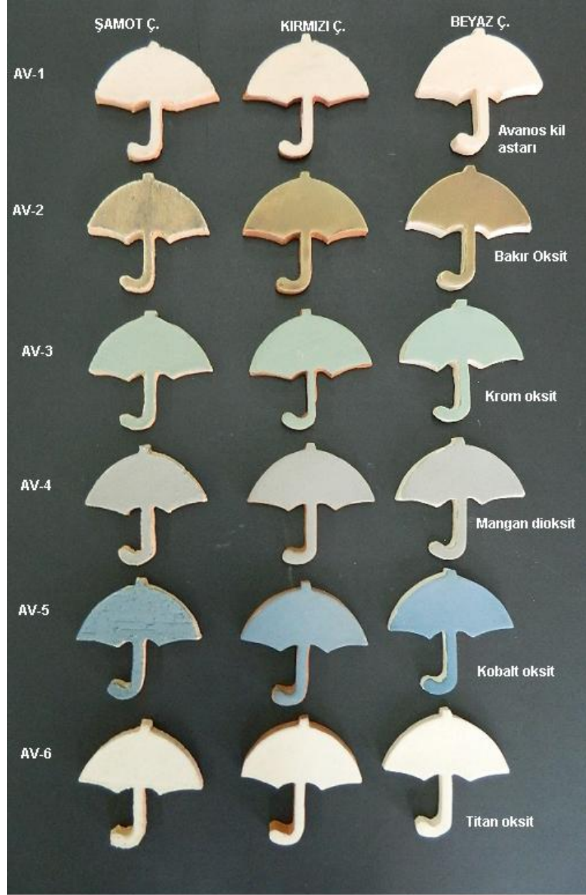
Resim 44: Avanos Kili ile hazırlanan astarın Metal oksitlerle renklendirilmesi
