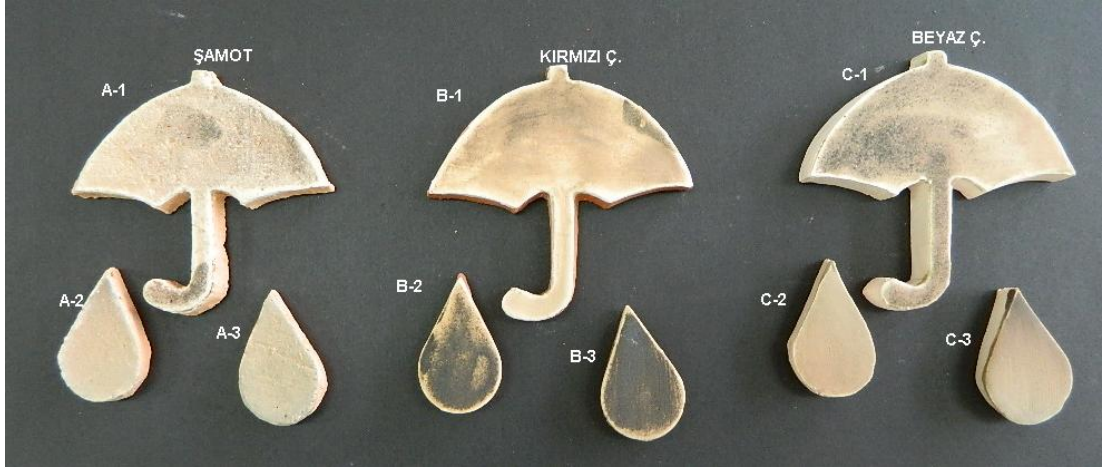
Resim 35: Söğüt Seramik Vakum pres çamuru astarı ile CuO (Bakır Oksit) ilavesi.
