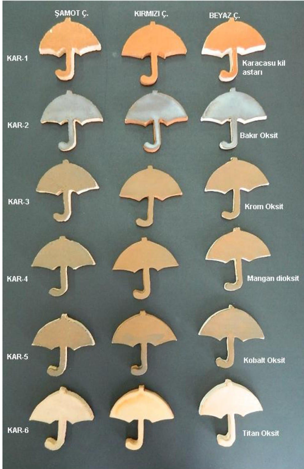
Resim 50: Karacasu Kili ile hazırlanan astarın Metal oksitlerle renklendirilmesi
