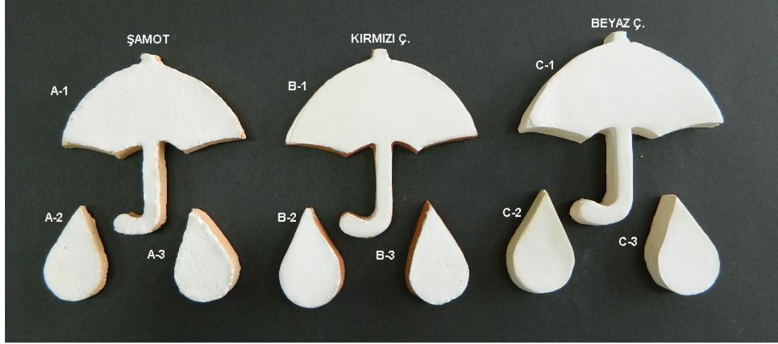
Resim 41:Söğüt Seramik vakum pres çamuruyla hazırlanan astarın TiO_2 (Titan oksit)'ile renklendirilme Denemeleri
