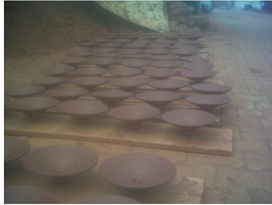
Resim15: Tornada çekilmiş kapaklar, Fotoğraf: Didem Akdemir
