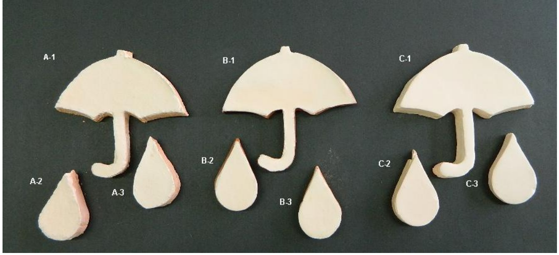
Resim 30: Çanakkale Çamuru Astarı ile TiO 2 (Titan oksit) Denemesi.
