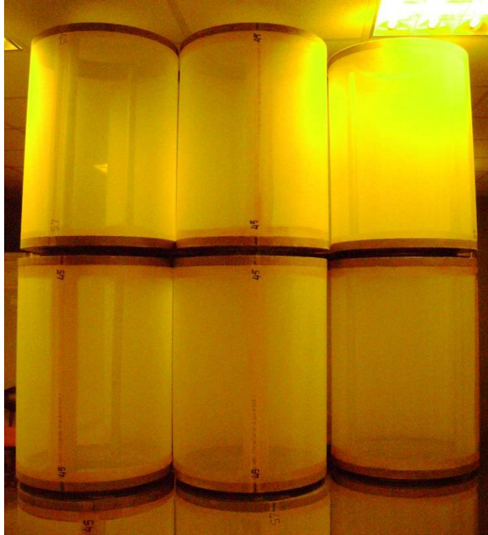
Resim 53- Elek Bezi Monte Edilmiş Tambur Örneđi Fotoğraf Aygöl Kafadar
