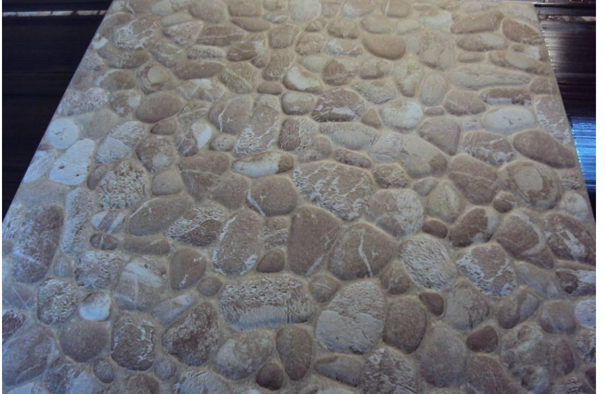
Resim 64- Dijital Baskı Uygulanan Ham Karo Görüntüsü
