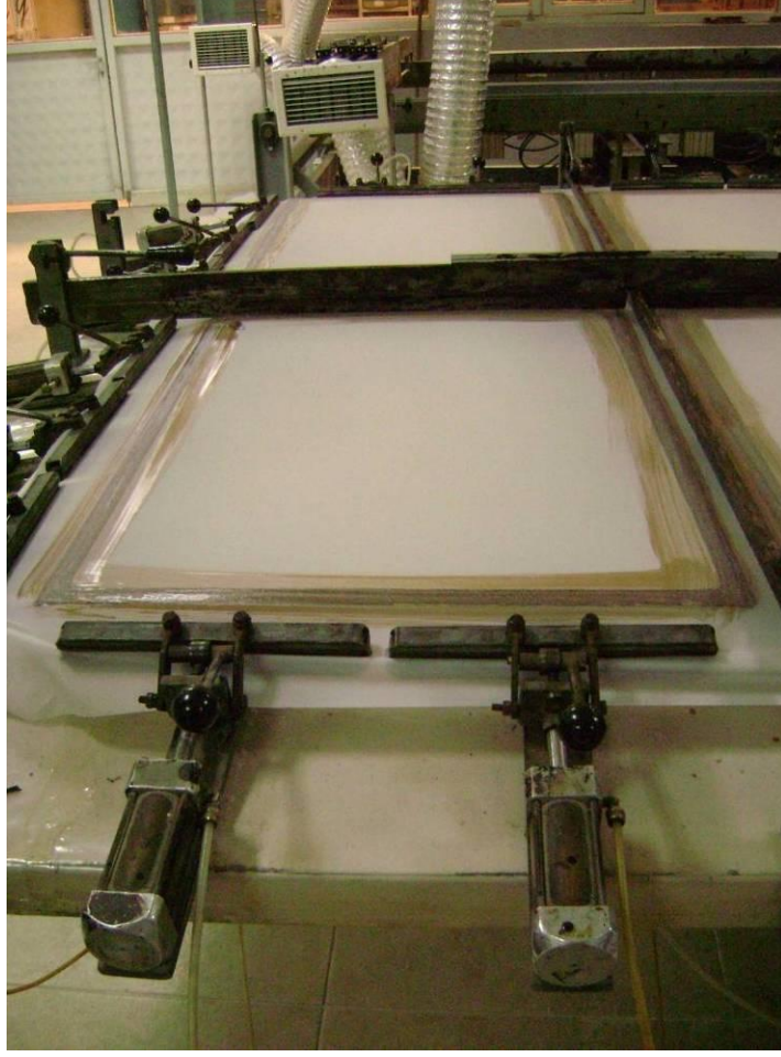
Resim 33- Elek Bezlerinin Kuruma Aşaması
