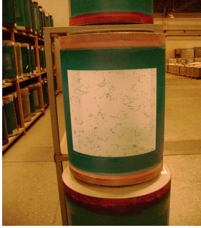
Resim 54- Pozlanmış Tambur Örneđi Fotoğraf Aygöl Kafadar
