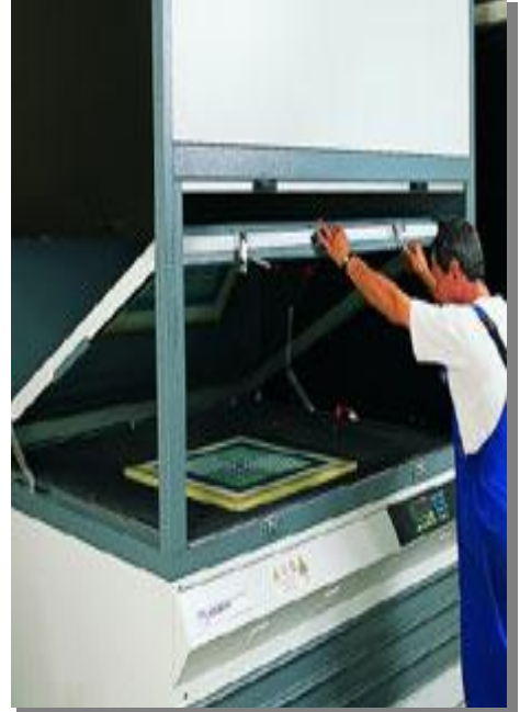
Resim 28- Elek Pozlama Çalışması
