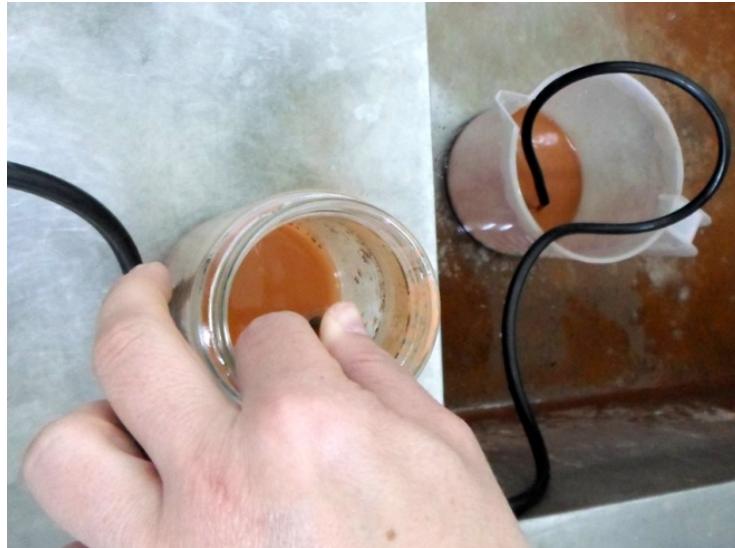
Resim 38: Astar olarak kullanılacak olan ilk tabakanın ince hortum yardımı ile çekilmesi.
