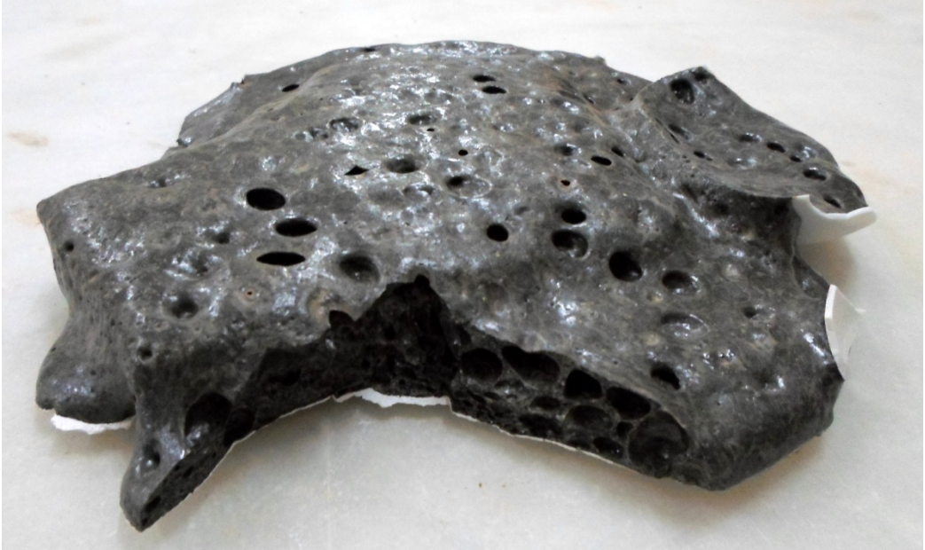
Resim 34: Klaz-1'in yüksek dereceye vereceği tepki denenmiş, 1250° C 'de erimiştir.
