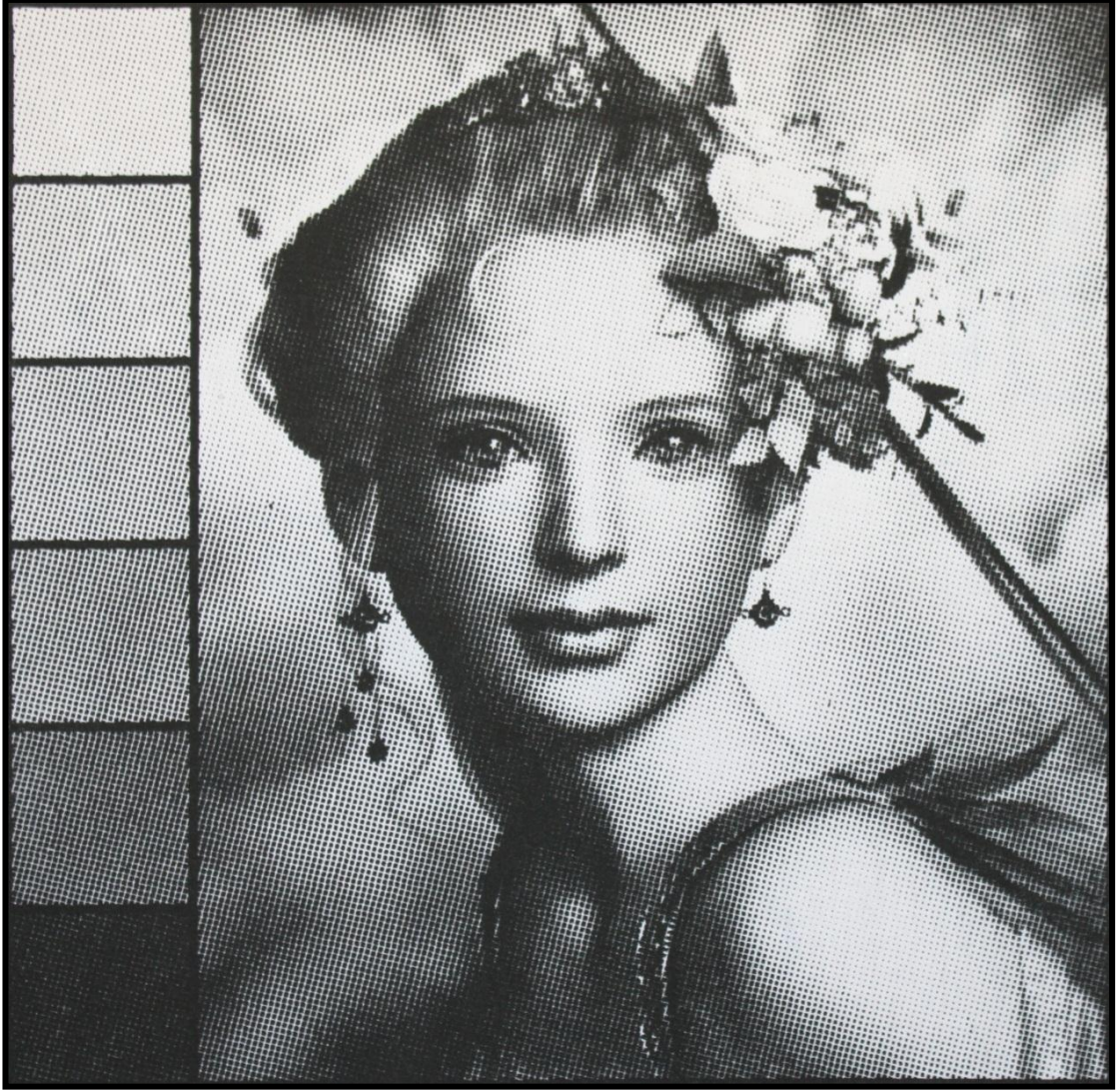
Fotoğraf 5: AM Tramlama Yöntemi ve 200 piksel/cm Çözünürlük Kullanılarak Gerçekleştirilen İpek Baskı Uygulaması
