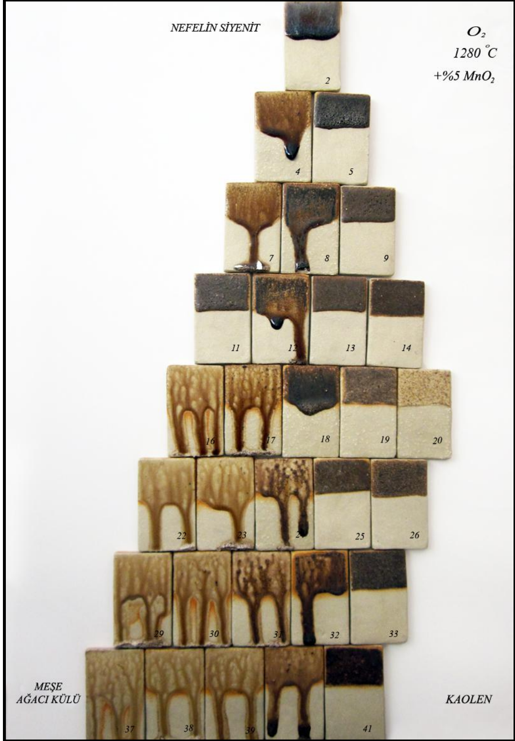
Resim 143: % 5 Mangan oksit katkılı sır denemeleri
