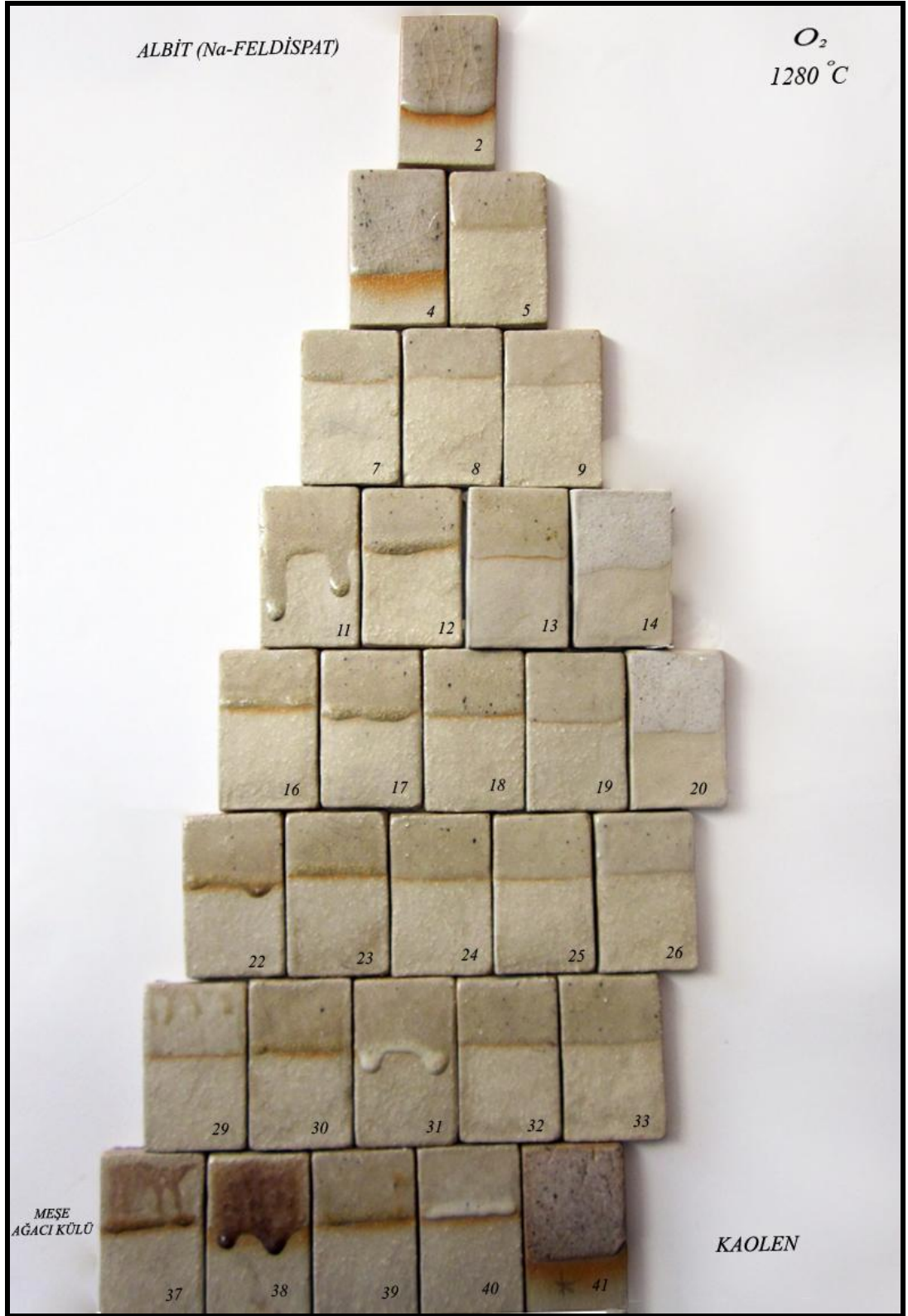
Resim 125: Meşe Ağacı Külü Denemeleri, Yükseltgen ortam, 1280°C/ temin edildiği yer: İzmir /Türkiye
