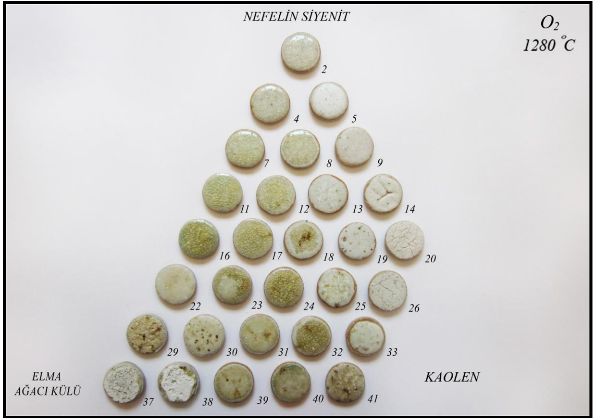
Resim 132: Elma Ağacı Külü Denemeleri, Yükseltgen ortam, 1280°C/ temin edildiği yer: Amasya /Türkiye
