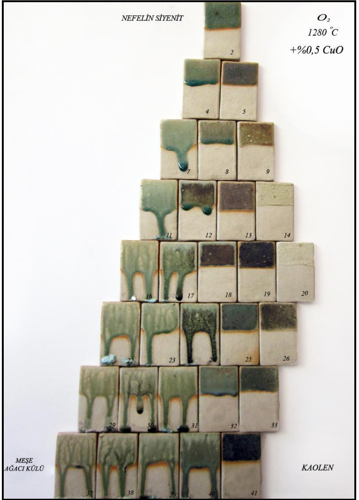
Resim 141: % 0,5 Bakır oksit katkılı sır denemeleri
