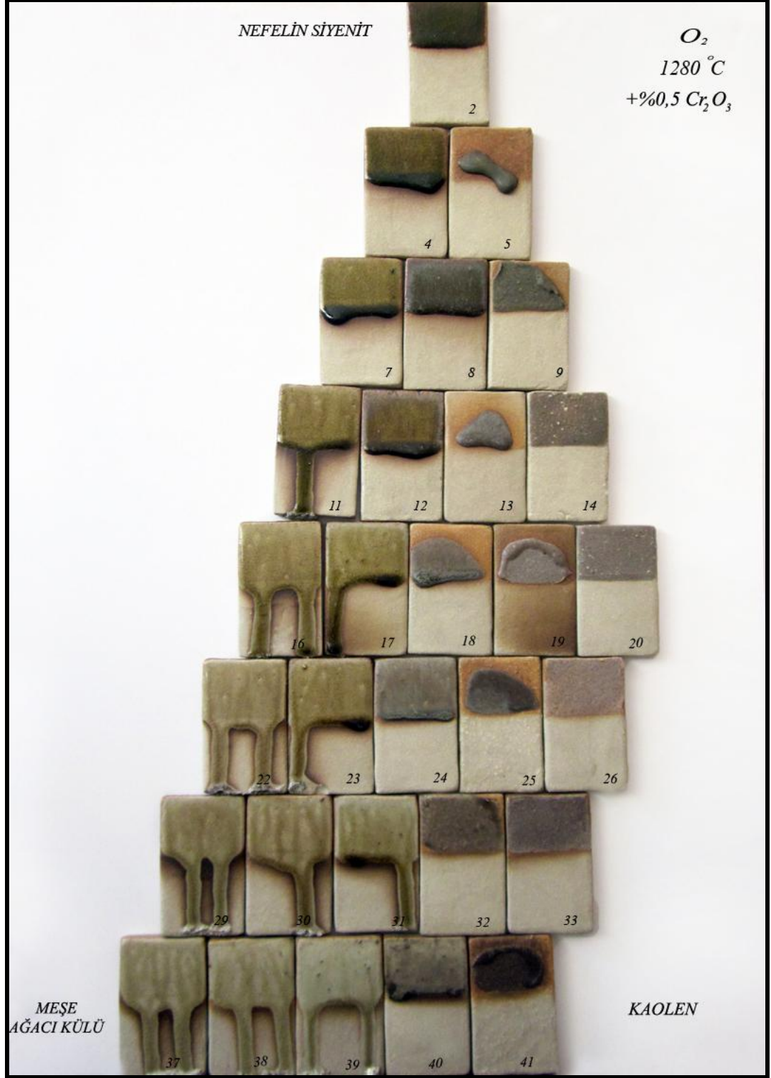
Resim 144: % 0,5 Krom oksit katkılı sır denemeleri
