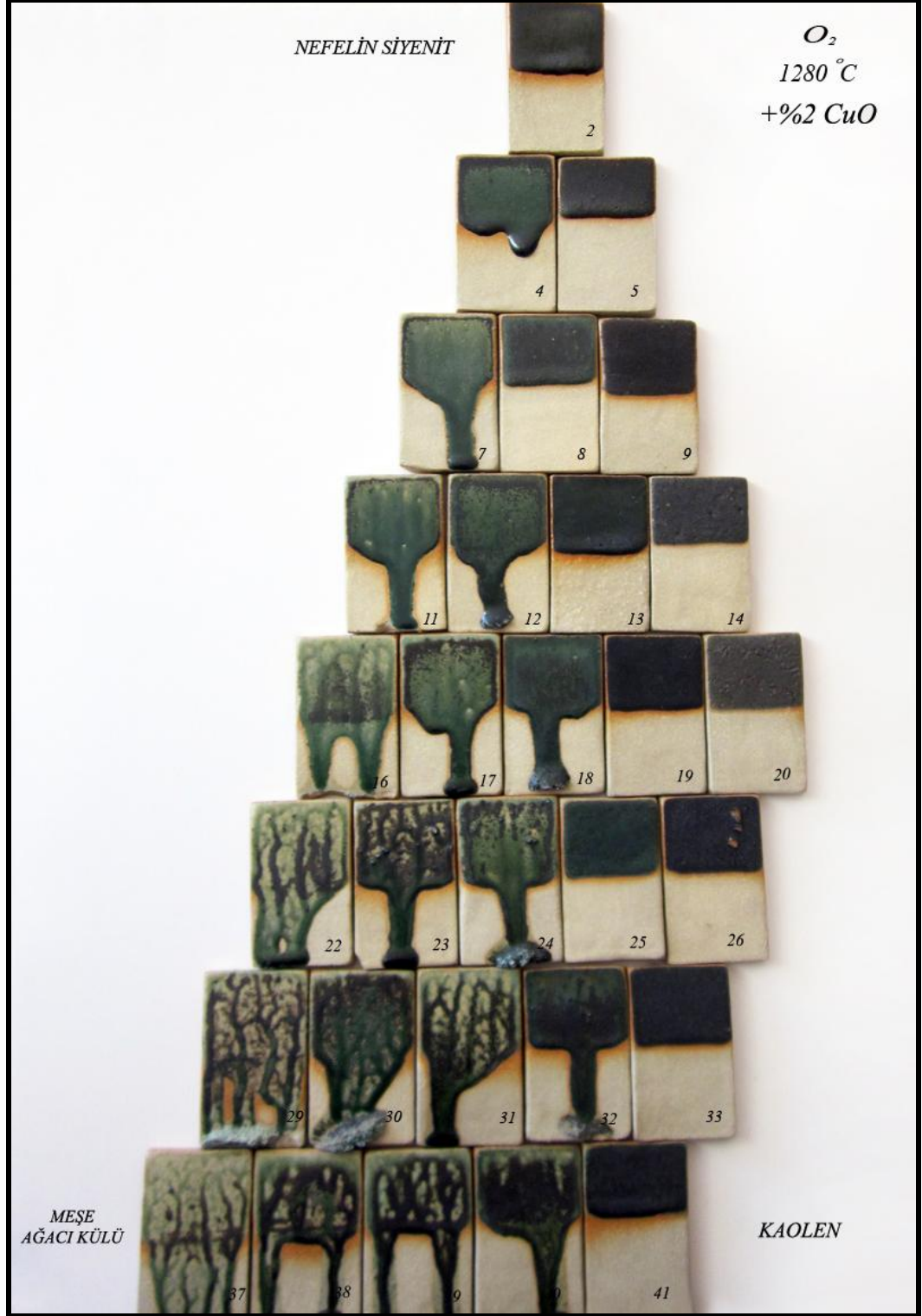
Resim 140: % 2 Bakır oksit katkılı sır denemeleri
