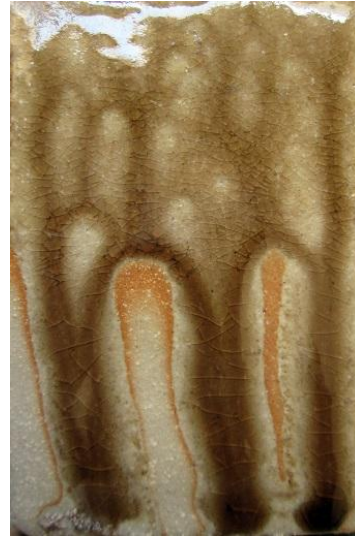
Resim 33: %70 oranında meşe ağacı külü içeren yüzey görüntüsü /Foto: Pınar Çalışkan Güneş
