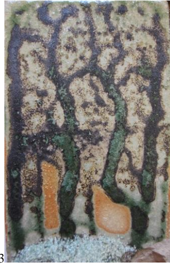
Resim 33: %70 oranında meşe ağacı külü içeren yüzey görüntüsü /Foto: Pınar Çalışkan Güneş
