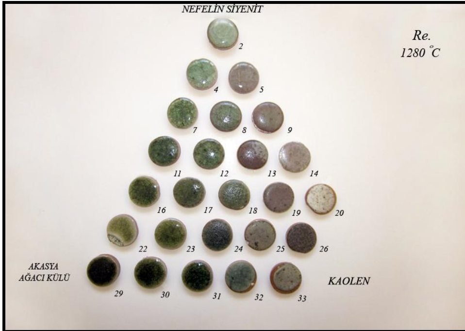
Resim 116: Akasya Ağacı Külü Denemeleri, İndirgen ortam, 1280°C/ temin edildiği yer: Koblenz / Almanya
