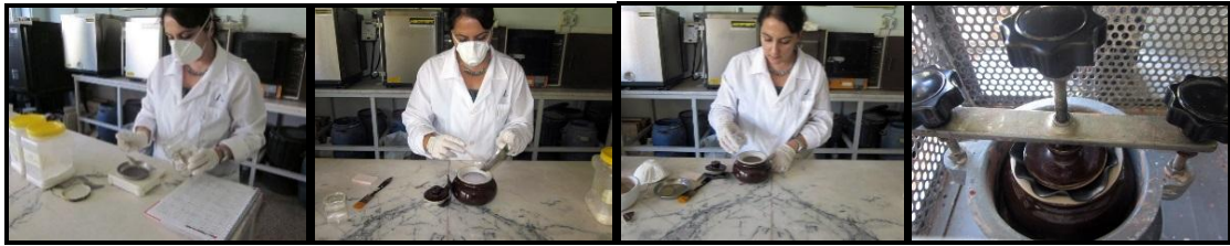
Resim 68-71: Hammaddelerin tartılması ve bilyeli değirmende öğütülmesi/Foto:Fahimeh Heydari
