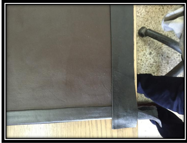
Resim-94: Hazırlanan řeritlerin yapıřtırılması ařaması.
