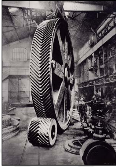
Görsel 15: Ringa balığı kemiği şekilli dişliler, ileride Citroën logosuna ilham olacak, https://upload.wikimedia.org/wikipedia/commons/5/53/Engrenages_-_85.488_.jpg
