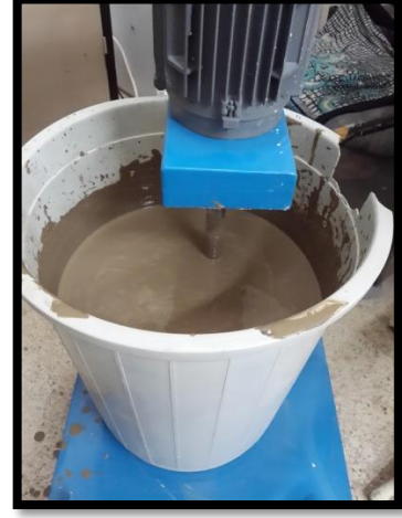
Foto.: 209 Döküm Çamuru Haline Getirilen Tokat Çamuru
