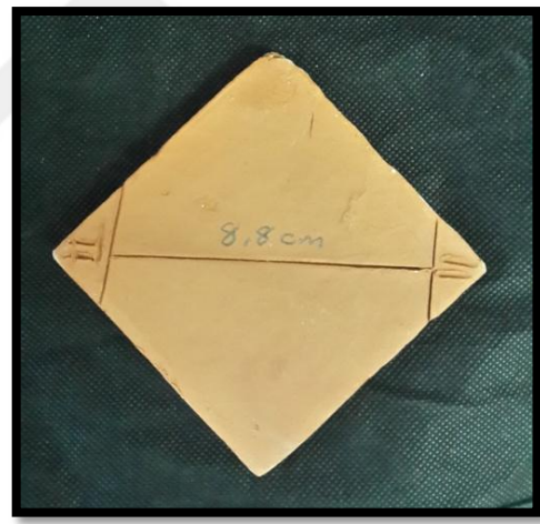
Foto.: 226 Pişirim Sonrası Toplam Küçülme
