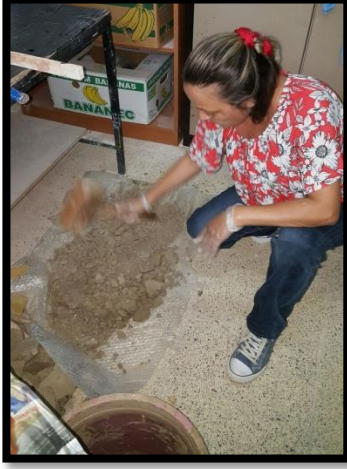
Foto.: 208 Kuru Çamurun Toprak Haline Getirilmesi
