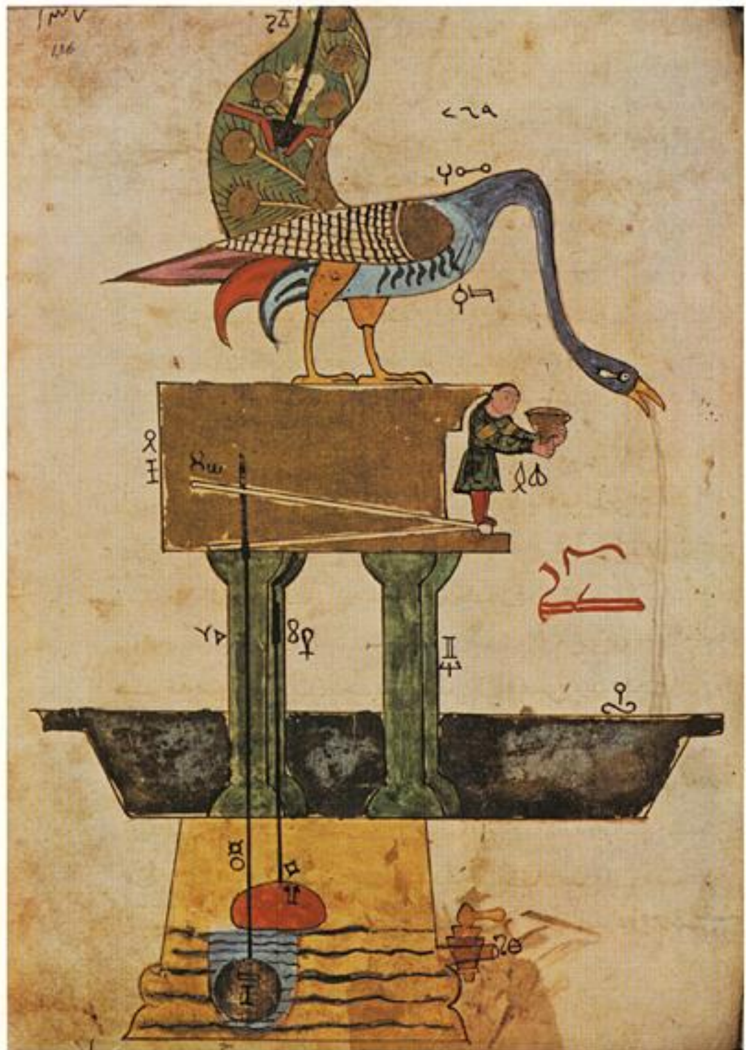
Resim 3: Tavus kuşu ağzından içki akıtan otomatik musluk (1206, Diyarbakır) (İstanbul Topkapı Müzesi Kitaplığı Hazine A.3472,H.414,Ahmed III,s.136a)
