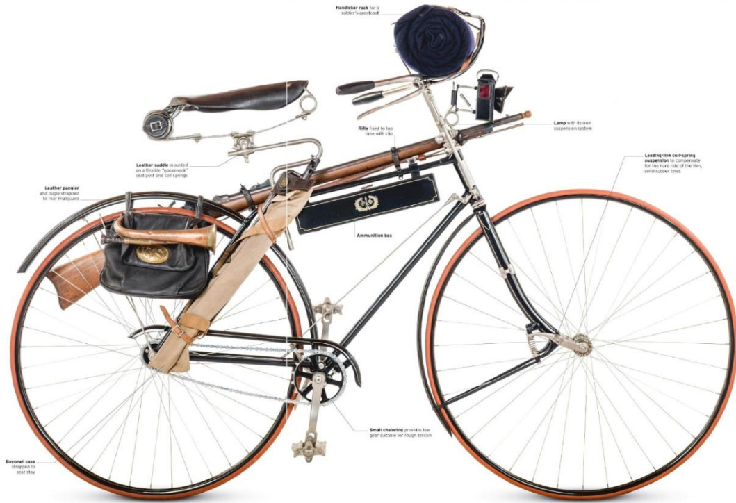
Resim 51: Columbia Askeri Bisikleti -Amerikan ordusunun 1891 yılında kullanmaya başladığı ilk askeri amaçlı emniyet bisikleti- (The Bicycle Book The Definitive Visual History, 2016: 30)
