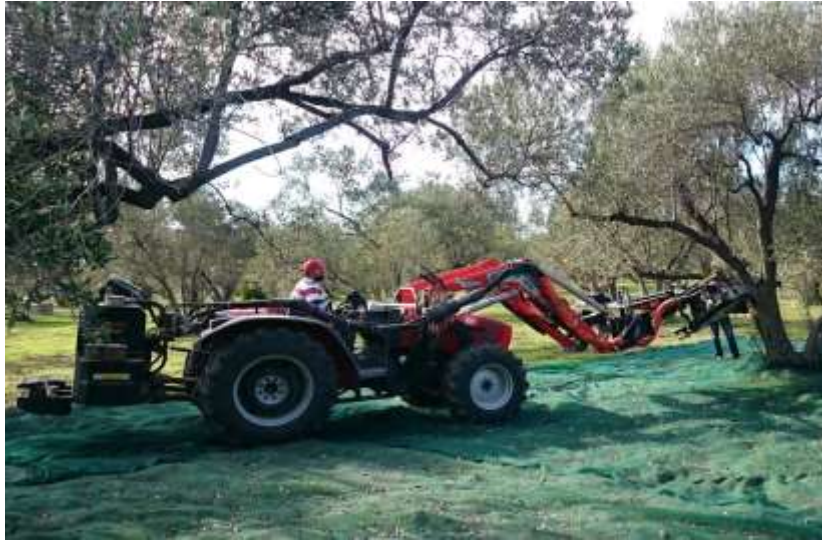
Fotoğraf 4.3. Zeytin bahçelerinde traktöre bağlı hasat aletlerine sıkça rastlanmaktadır.
