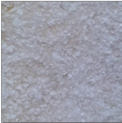
Şekil 102- Hamurda Gözlenen Lif Düğümleri
