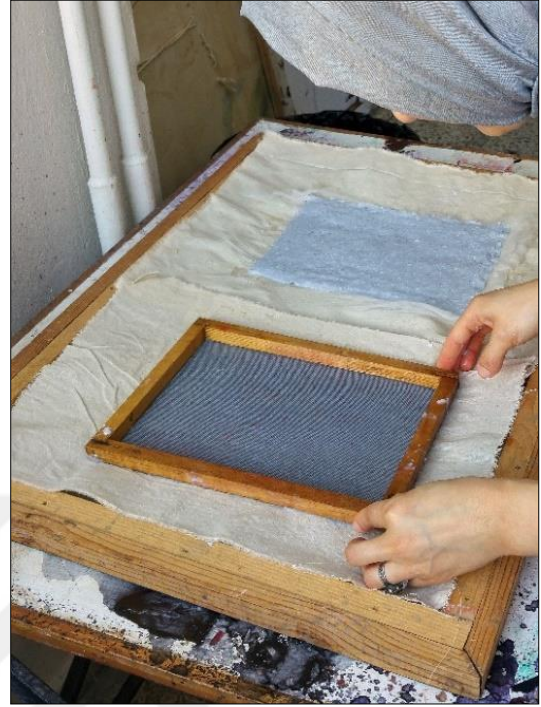
Şekil 56- Sandviç Yapılı Kompozitin İlk Katmanının Oluşturulması
