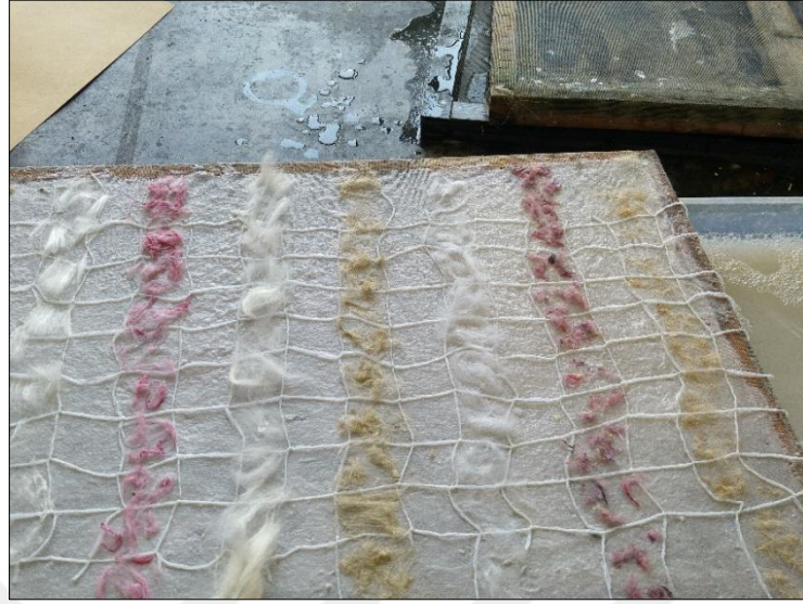
Şekil 119- Kompozit No: 33 Sandviç Yapılı Kompozitin Ara Yüzeyinin Oluşturulması
