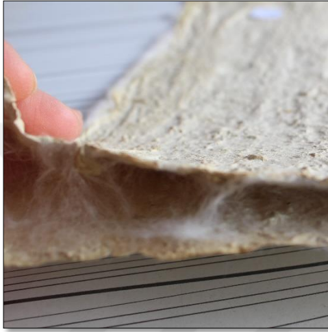
Şekil 71- Sandviç Yapılı Kompozitin Ara Yüzeyinde Yetersiz Bağ Oluşumu
