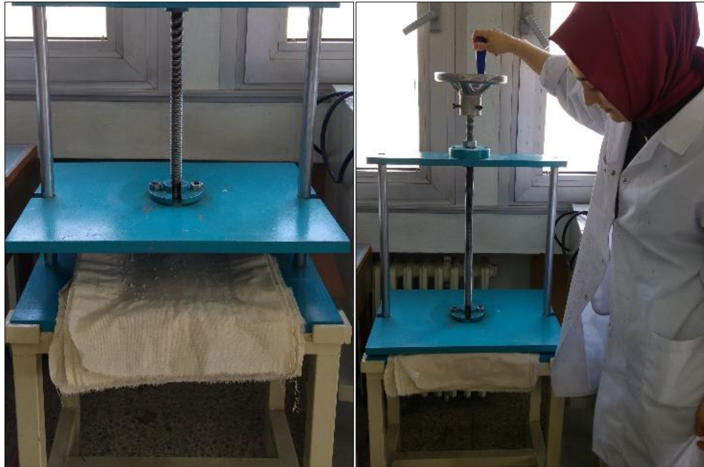
Şekil 33- Keten Kumaşlar Arasındaki Kompozitlerin Preslenme Aşaması
