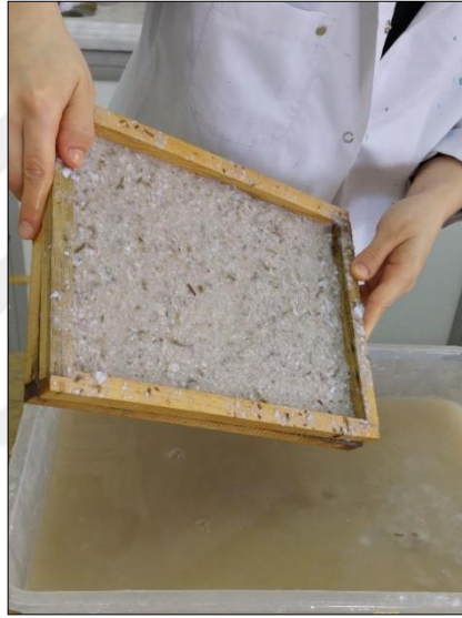
Şekil 41- Kalıp Üzerindeki Liflerin Görünümü ve Kalıp Çıkarılmadan Önce Fazla Suyunun Süzülmesi
