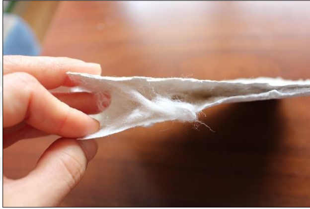
Şekil 59- Sandviç Yapılı Kompozitte Bağ Oluşumu Oldukça Zayıf Ara Yüzey Görünümü
