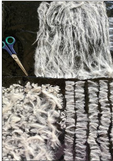
Şekil 57- Kesiksiz, Düzensiz ve Kesikli Yerleştirme Biçimleriyle Pamuk Elyafı
