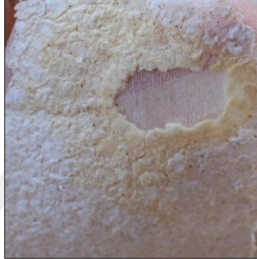
Şekil 110- Pirinç Kepeği Posası Kullanılan Kompozitte Sud Kostigin Etkisi
