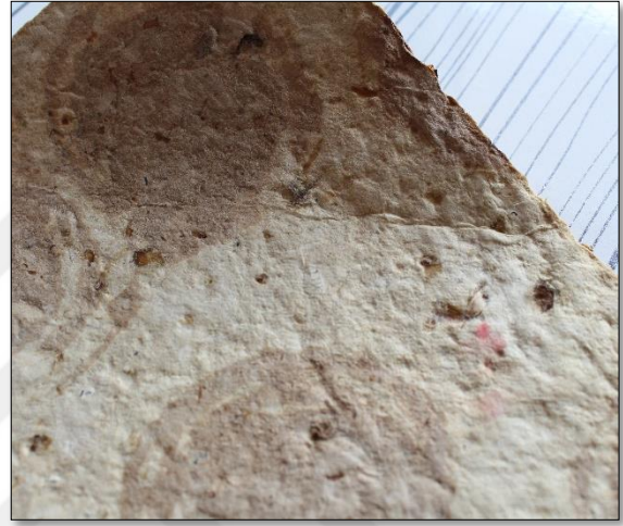
Şekil 72- Devore Baskı İşlemi Görmüş Pamuk Elyafı Takviyeli Kompozit Uygulama
