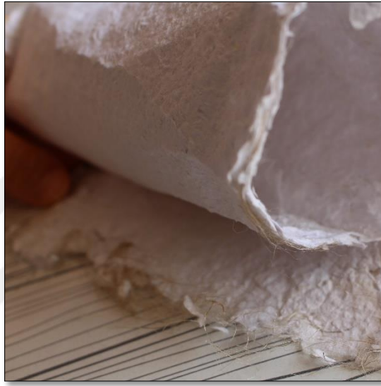
Şekil 106- İkincil (sekonder) Lif ve Keten Elyafı Kullanılan Kompozit Uygulamada Gözlenen Kırılmalar
