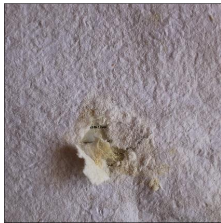
Şekil 115- Jüt ve Sodyum Aljinatın Bir Arada Kullanıldığı Kompozitte Sudan Kostinin Etkisi
