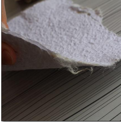
Şekil 104- Soya Elyafı Takviyeli, Sandviç Yapılı Kompozit
