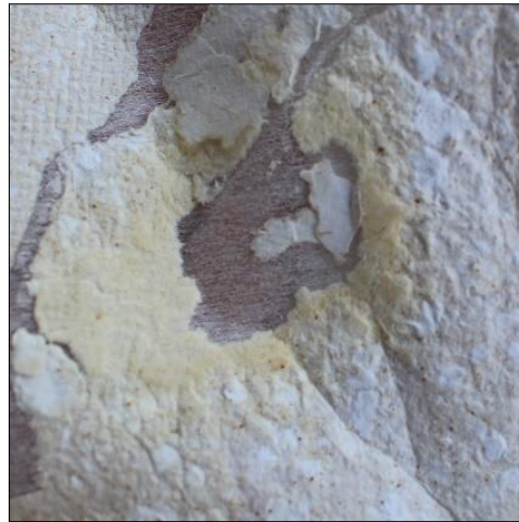
Şekil 112- Pirinç Kepeği Posası ve Sodyum Aljinatın Bir Arada Kullanıldığı Kompozitte Kostik Etkisi
