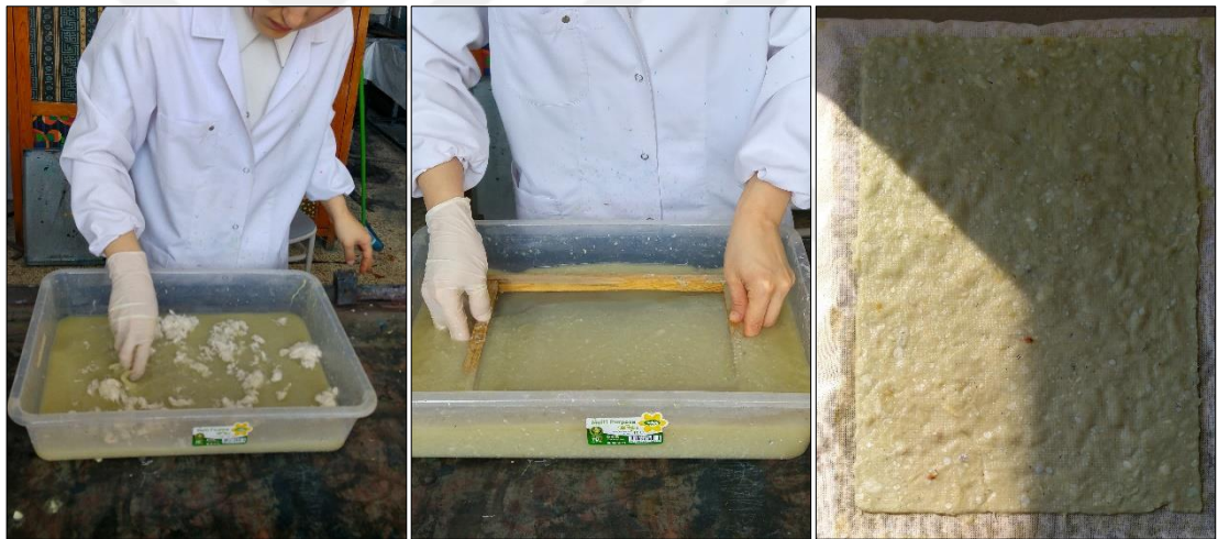
Şekil 70- Pamuk Elyafının Kırık Halde Banyo Suyuna Karıştırılması ile Elde Edilen Kompozit Uygulama Aşamaları
