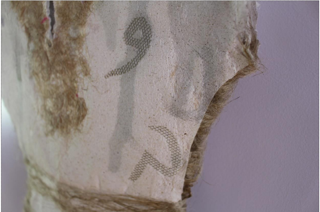
Şekil 152- Keten Lifi Kullanılarak Birleştirilen Kompozit Parçalar
