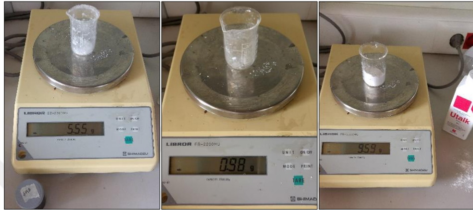
Şekil 94- Şap, jelatin ve pudra belirlenen ölçülerde tartılarak banyo suyuna ilave edilmiştir.
