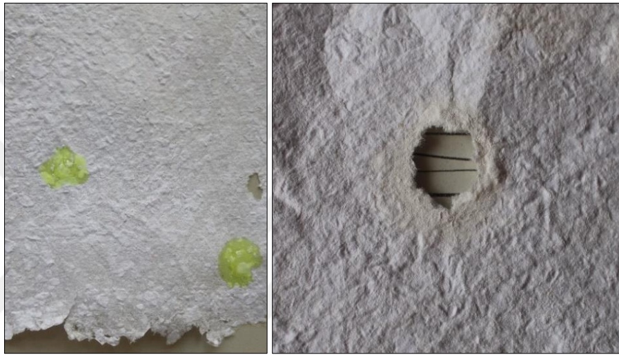
Şekil 101- Kompozitte Sud Kostikle Doku Zayıflatma Denemesi
