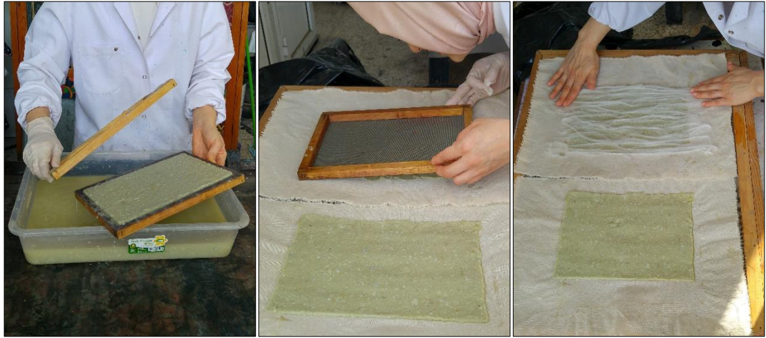
Şekil 69- Pamuk Elyafının Kesiksiz Yerleştirilmesiyle Sandviç Kompozit Uygulama Aşamaları
