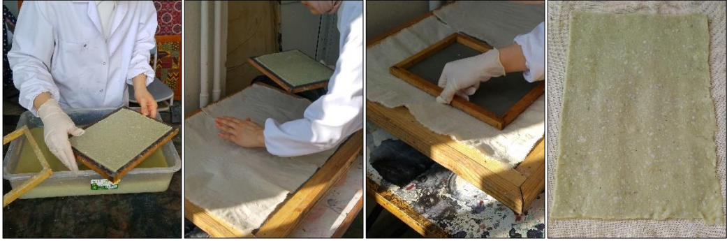
Şekil 67- Banyo Suyundan Alınan Hamurun Kâğıt Kalıbından Ayrılarak Kurumaya Bırakılma Aşamaları
