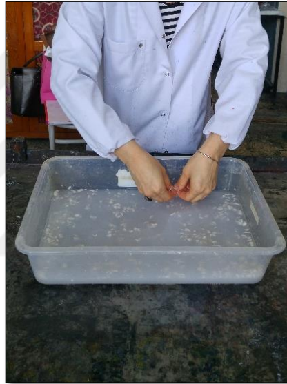
Şekil 83- Pamuk Elyafının Banyo Suyunda Dağıtılması
