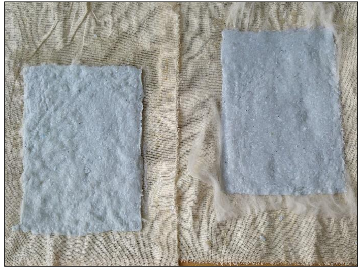
Şekil 58- Farklı Yerleştirme Biçimleriyle Pamuk Elyafının Kullanıldığı Sandviç Yapılı Kompozit Uygulamalar
