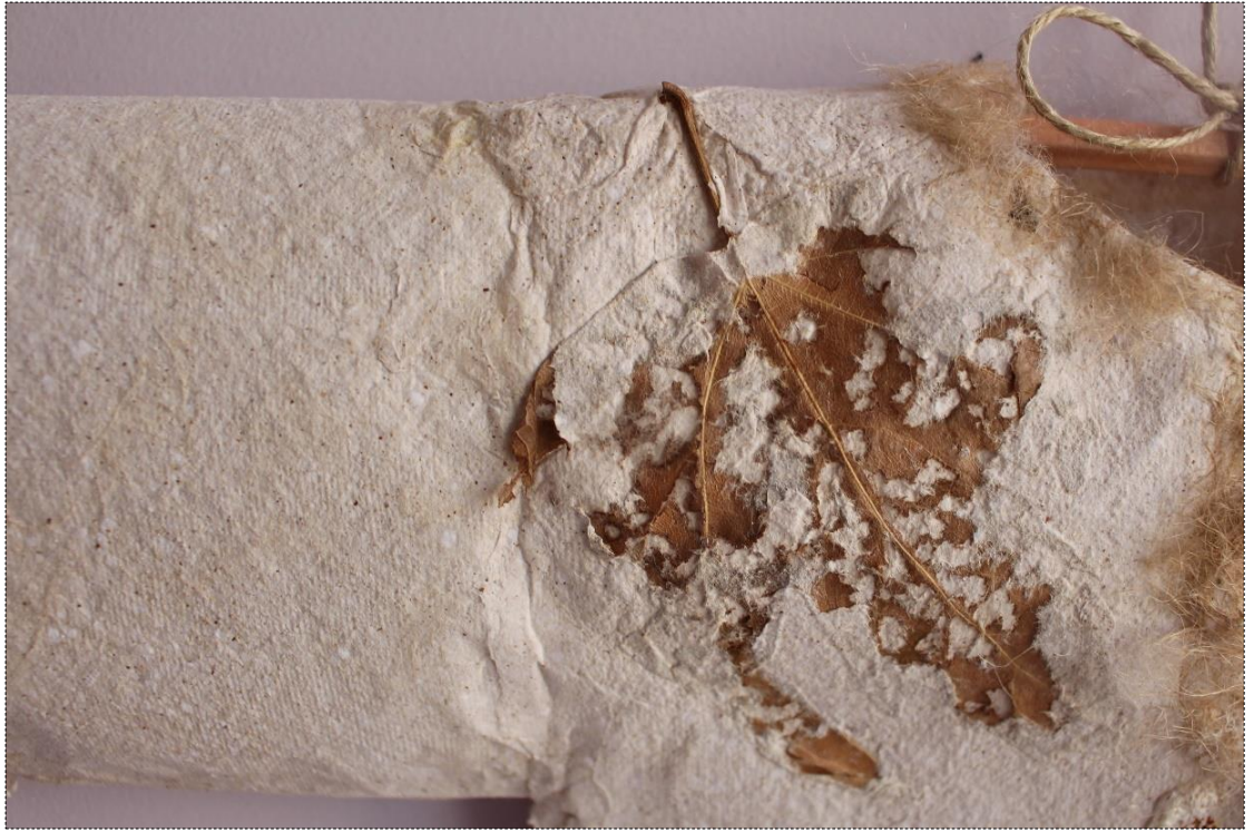
Şekil 145- Sandviç Yapılı Kompozite Yerleştirilmiş Yaprak Detayı
