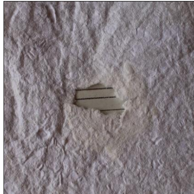
Şekil 108- Sodyum Aljinat Kullanılan Kompozitte, Sud Kostığının Etkisi
