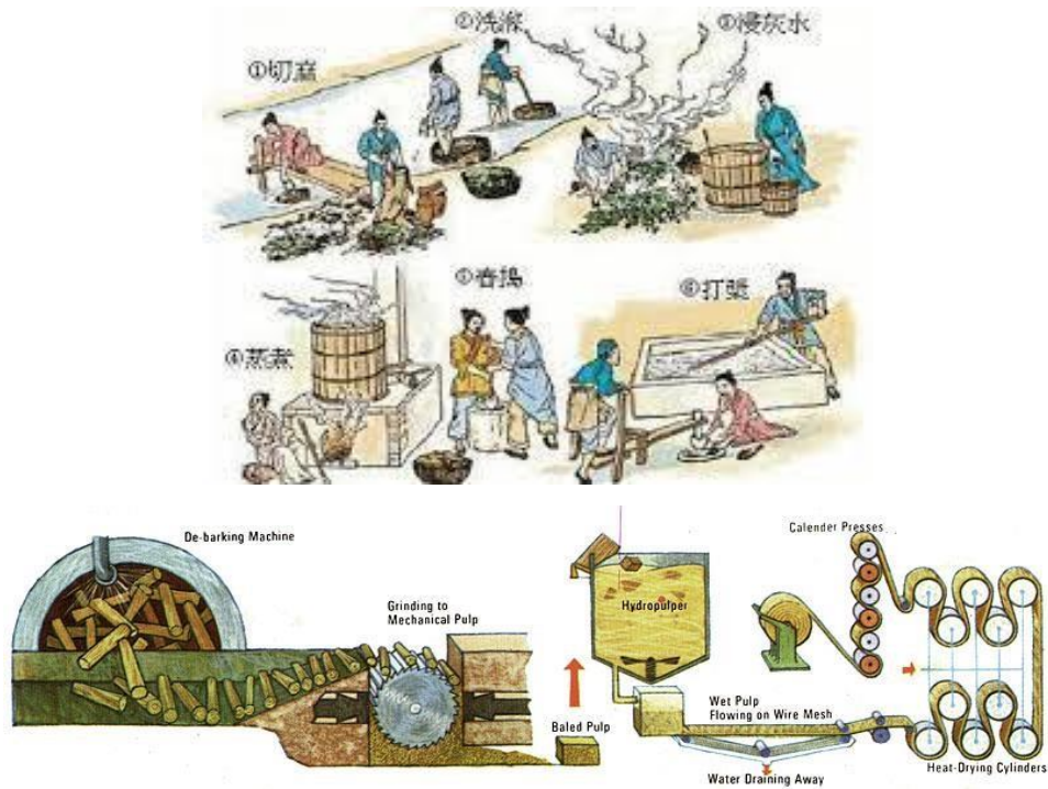
Şekil 2- Elde Kâğıt Üretimi ve Termomekanik Kâğıt Hamuru Üretimi (Çelebi,2017: 1)
