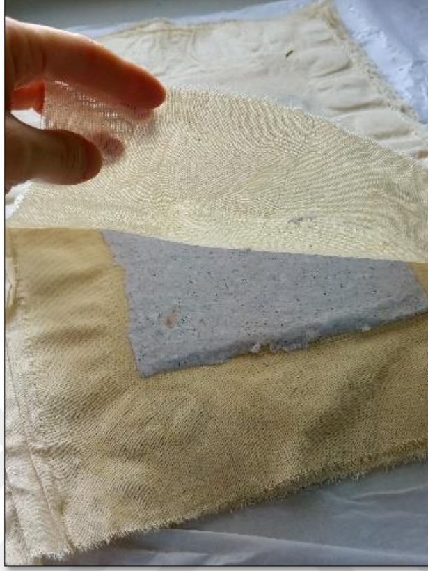
Şekil 32- Keten Kumaş Arasında Kurumaya Bırakılmış Kompozit Uygulaması
