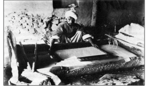
Resim 24: Keşmir'de kâğıt yapımı (1917). Kâğıt hamurunun güneşte kurutulup beyazlatılması (Al-hassan ve Hill, 1917:193).
