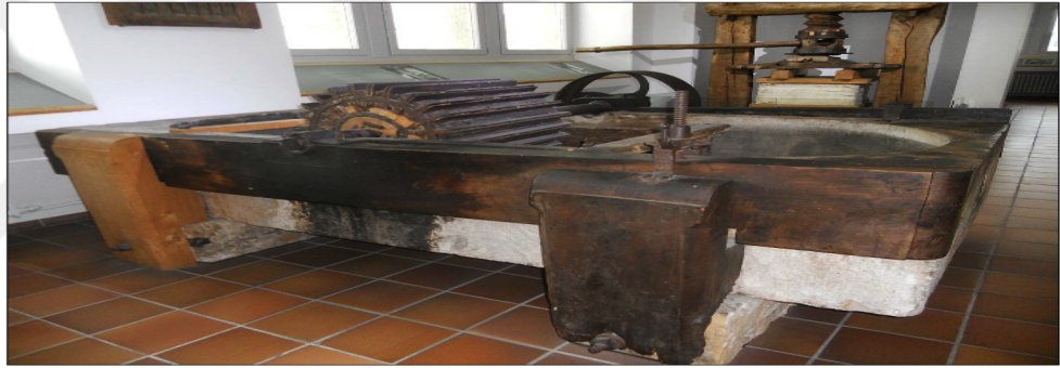
Resim 49: 18. yüzyılda Fransa'daki L'anglée Kâğıt Fabrikası'nda su çarkı ile çalıştırılan hollanderler. Burada bir su çarkı üçü bir yanda ve diğer üçü de öbür yanda olmak üzere altı tane hollanderi çalıştırmaktadır (Diderot, D. 1959, Levha 359).
