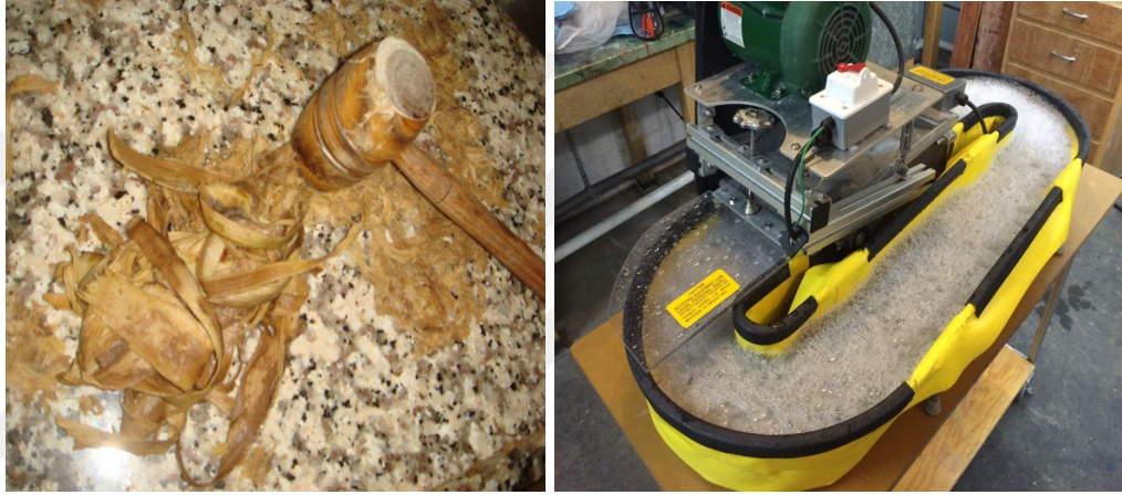
Resim 55: Dövme ve Diskli Rafinör(Hollander)
