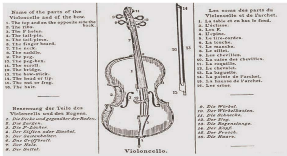
Şekil 4.1. Viyolonselın fiziksel yapısının tanımlanması
