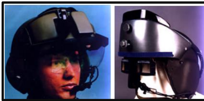
Şekil 2.2. Başa monte edilen optik tabanlı AG sistemi (Azuma, 1997)
