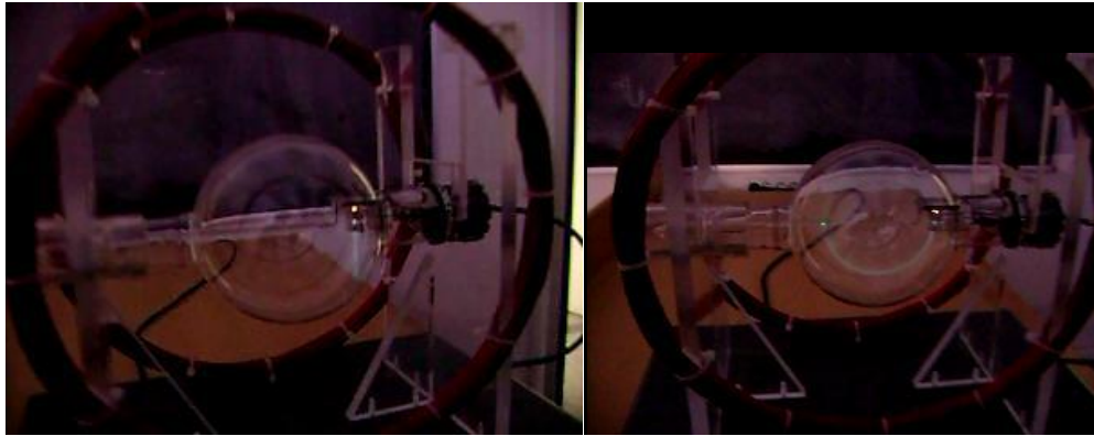
Şekil 3.8. Manyetik alanda hareket eden yüklü parçacığa etkiyen kuvvet deneyi
