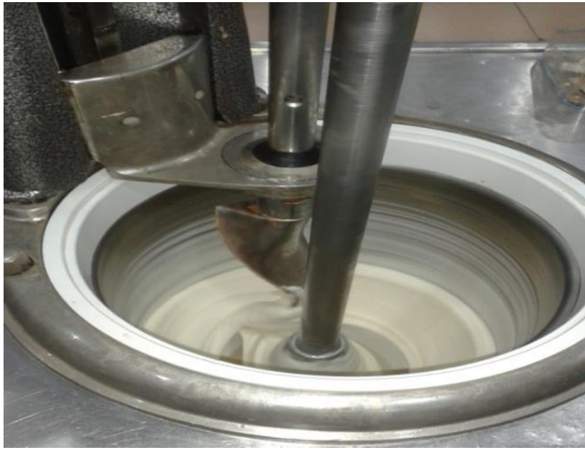
Şekil 3.2. Kesikli dondurucu kullanarak kefir dondurması üretimi
