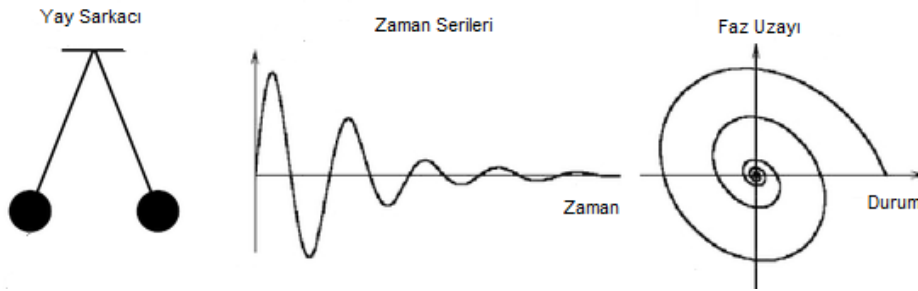
Şekil 2.1. Sarkaç salınımı için zaman serisi grafiği ve faz uzayı (Hasse ve Bekker, 2016)
