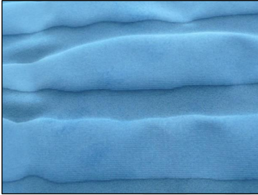
Resim.2.3. Flock baskı ve köpük rölyef baskı (İnternet 2)
