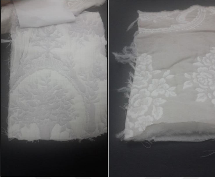
Resim.2.24. Dolgu ipliği kullanılarak dokunan rölyef kumaşın işlem öncesi ve sonrası görünümü, Perka Tekstil Koleksiyonu (Berber, 2018)
