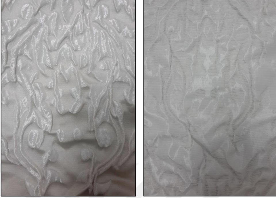
Resim 2.23. Termoplastik özellikli iplik ve polyester ile dokunmuş rölyef kumaşın ön ve arka yüzü, Perka Tekstil Koleksiyonu (Berber, 2018)
