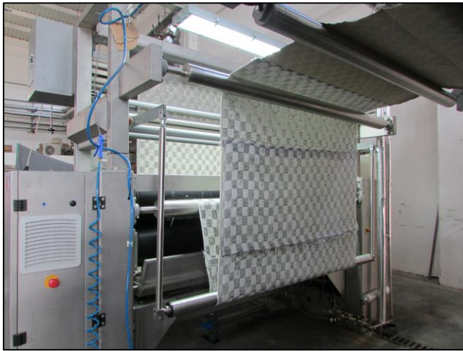
Resim.3.17. Kuru apre makinası ön yıkama işlemi (Berber, 2018)
