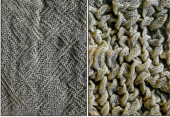
Resim.2.15. Krepe yün 58/2 Nm iplik solda atkı ve çözgü Z bükümlü, sağda atkı S büküm, çözgü Z büküm sonucunda oluşan doku farklılıkları (Richards, 2012, s. 48)
