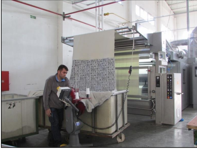
Resim.3.16. Kuru apre makinası kılavuz kumaş dikimi (Berber, 2018)
