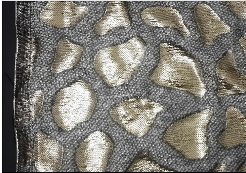
Resim.2.26. Keten, termoplastik özellikli ve metalik iplik karışımı parlak-mat dokuma, Perka Tekstil koleksiyonu (Berber, 2018)
