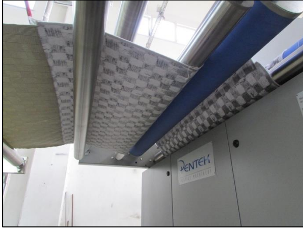
Resim.3.21. Kuru apre sonrası ızgara bölümünden çıkan kumař (Berber, 2018)
