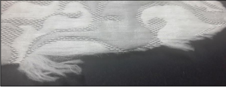
Resim.2.33. Dolgu atkısı ile oluşturulan çift katlı bir dokuma örneği ve ayrıntısı, Perka Tekstil 2017 koleksiyonu (Berber, 2018)
