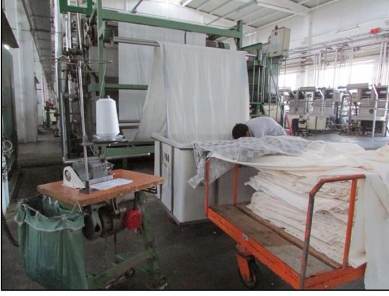
Resim.3.12. Kılavuz kumaş dikim işlemi (Berber, 2018)
