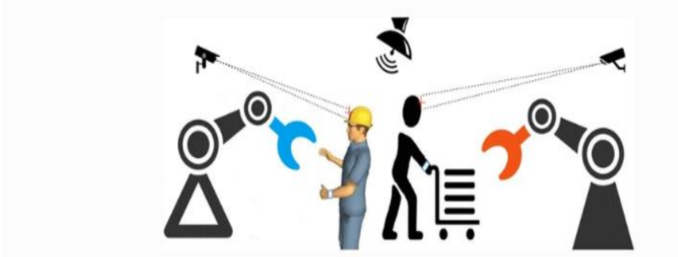
Şekil 37: Birden fazla Tanımlamaya ihtiyaç duyulan çok katılımlı bir iş birlikçi çalışma alanı senaryosu
