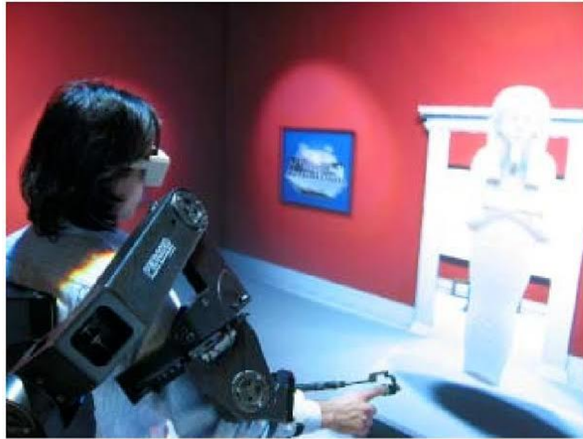
Şekil 3.6: VR gözlüğü ve iki nokta bağlantılı dokunsal cihaz ile deneyimlenen heykel, "The Museum of Pure Form: Touching Real Statues in An Immersive Virtual Museum" (Loscos ve diğ., 2004).
