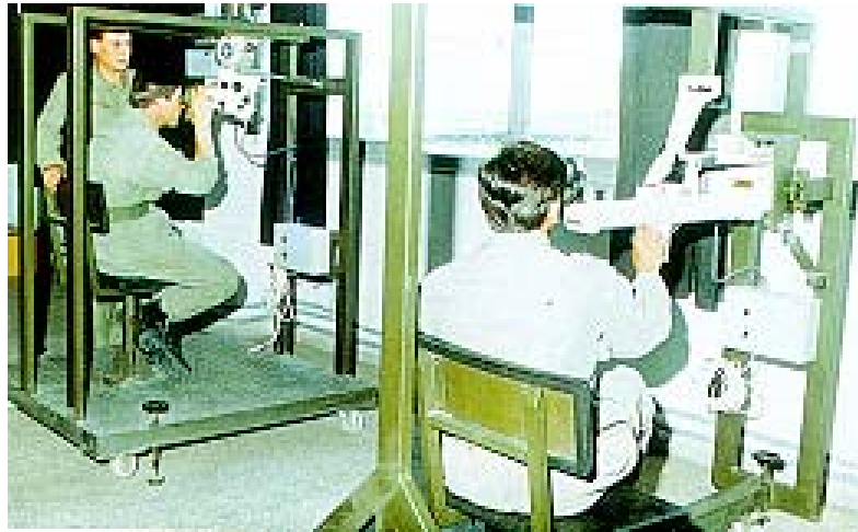
Resim-33 Tank Nişan Aletleri Montaj Sehpaları. (Kaynak:Zırhlı Birlikler Bülteni Yıl:8, Sayı:20, Ekim 2004)
