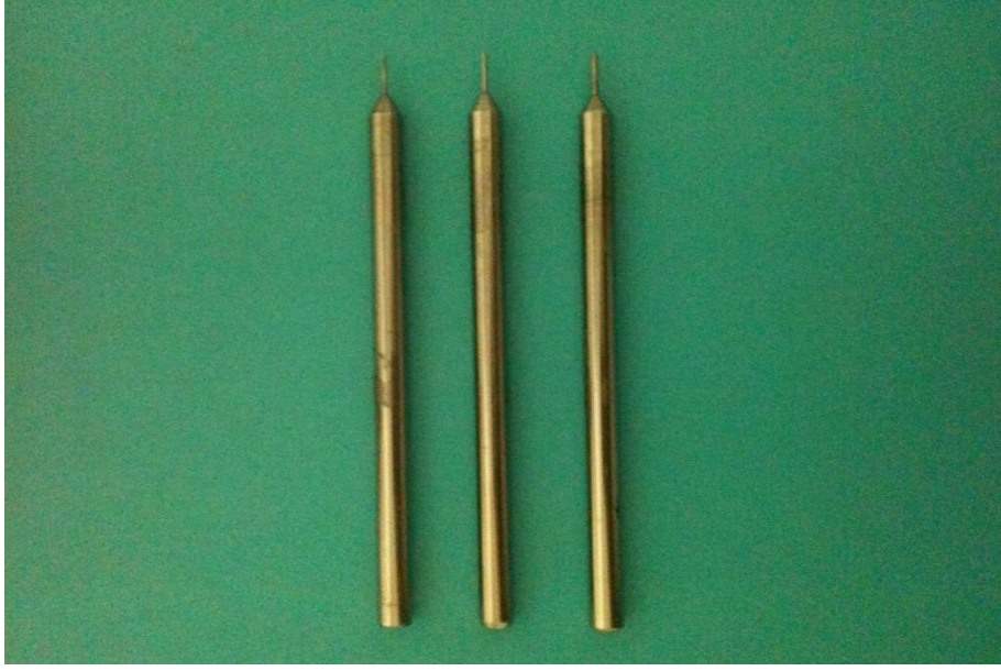
Şekil 2.35. Push out deneyinde kullanılan 1.2 mm, 1mm ve 0.8 mm çaplarındaki metal uçlar
