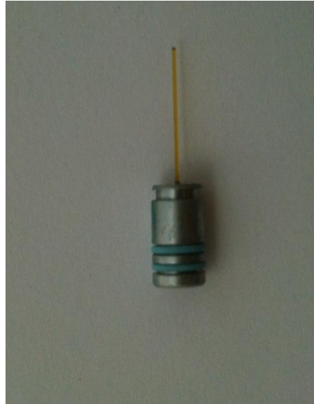
Şekil 2.14. Er:YAG Lazer'e ait 300 µm'lik PIPS fiber optik uç
