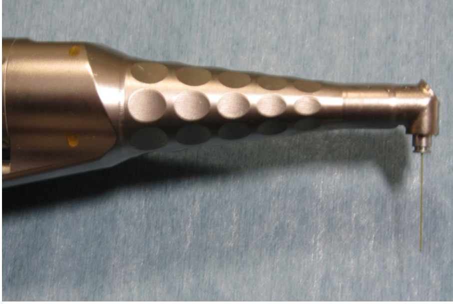
Şekil 2.11. Er:YAG Lazer'e ait 300 µm'lik fiber optik uç
