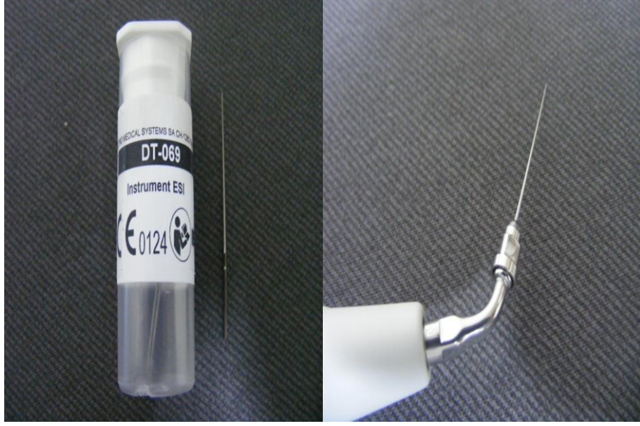
Şekil 2.2. Çalışmamızda kullanılan paslanmaz çelik ultrasonik uç
