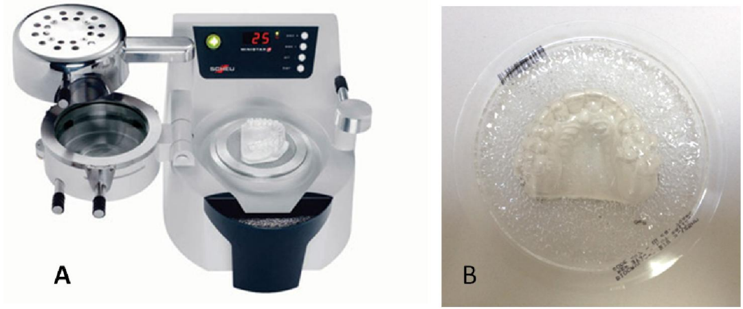
Şekil 2-1. Termal kontrollü vakumlu makine (BIOSTAR) (A) ve alçı modele adapte edilmiş 2 mm kalınlığındaki sert, şeffaf biokril plak (B).
