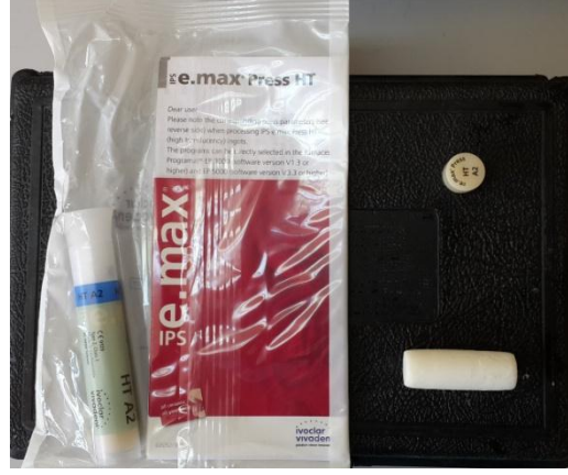
Şekil 2-5: Silikon Manşetten Çıkarılmış Revetman ve IPS e.max Press HT İngot
