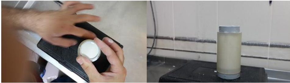
Şekil 2-4: Revetmana Alınma ve Sonrasında Donma Aşaması
