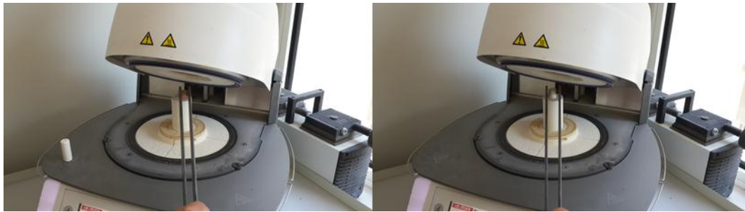
Şekil 2-6: Revetmanın Fırın ve Pres İşlemleri
