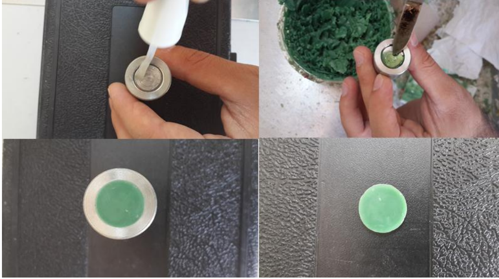
Şekil 2-1: Pres Örneklerine Ait Mumların Hazırlanma Aşamaları
