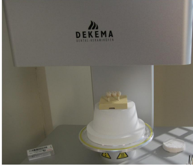
Şekil 2.22 Solid zirkon köprünün glaze fırınana girme aşaması
