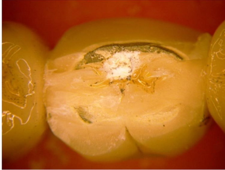
Şekil 3.1 Metal destekli seramiklerin kırılma bölgeleri
