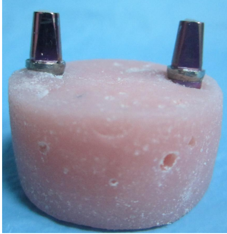
Şekil 2.3 Dayanakların akril kalıba gömülmüş hali
