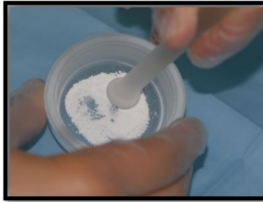
Şekil 2.3. Şeker/film kaplaması uzaklaştırılan tabletlerin havan ve havan eli yardımıyla ezilip toz haline getirilmesi
