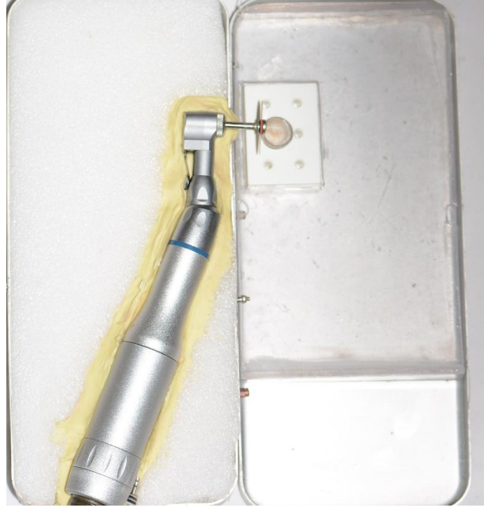
Şekil 2.7 Stripping işlemi sırasında standardizasyon sağlamak amacıyla yapılan düzenek
