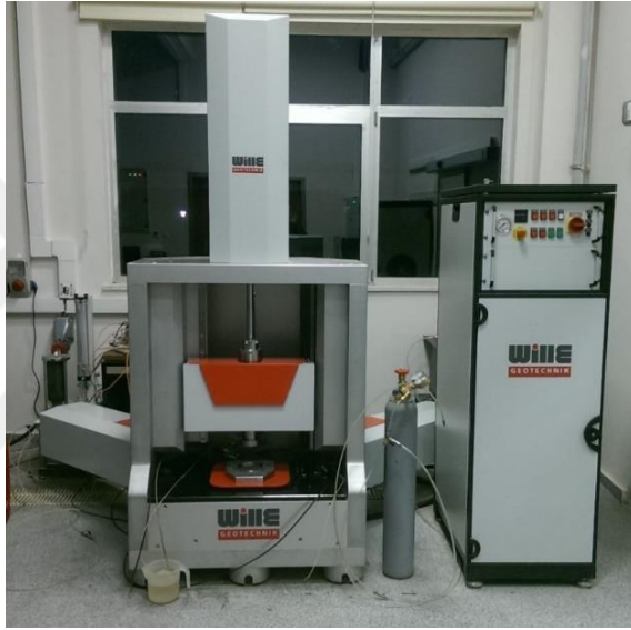
Şekil 2.3. Deneylerde kullanılan dinamik basit kesme test cihazı
