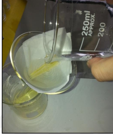
Fotoğraf 4.6. Örneklerin filtreli kağıt üzerinde saf su ile çözüldüğü arındırılması
