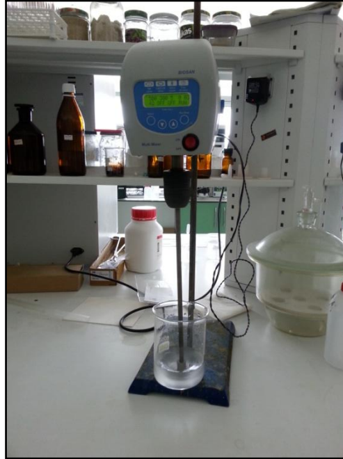
Fotoğraf 4.7. Laboratuvar mikserinde liflere ayrıştırma
