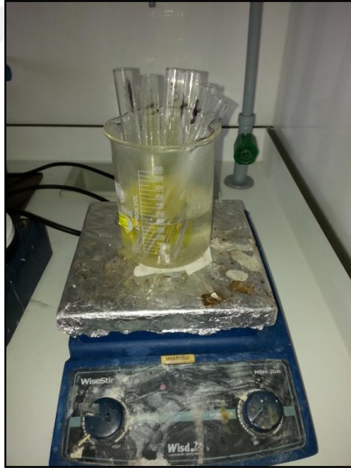
Fotoğraf 4.5. Laboratuvar ocağında kaynamaya bırakılan örnekler
