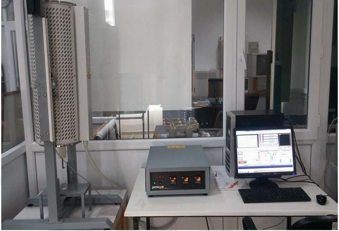
Şekil 4.2. Nano ince filmler için daldırma sistemi
