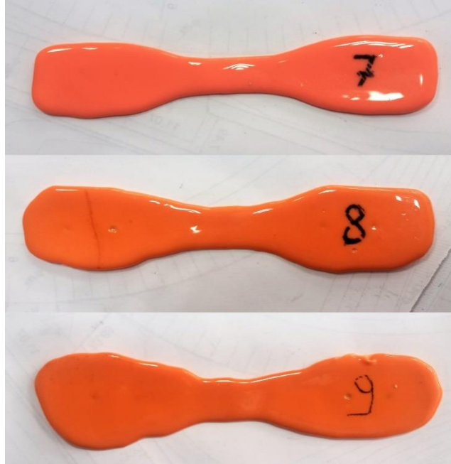
Fotoğraf 5.2. 200 °C’de erimiş numuneler
