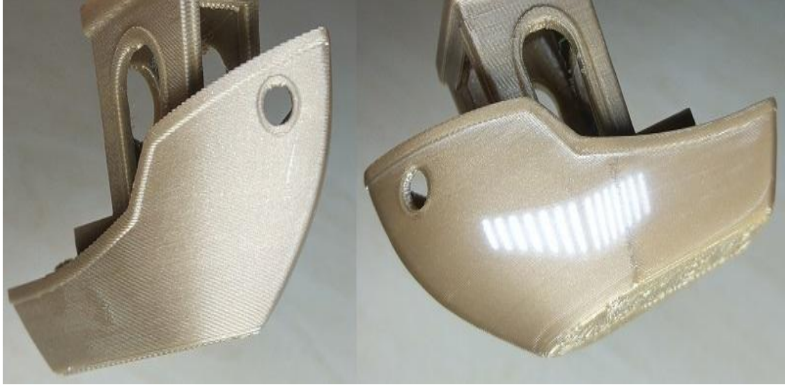
Fotoğraf 2.10. 3B modele yapılan zımparalama işleminin öncesi ve sonrası [24]
