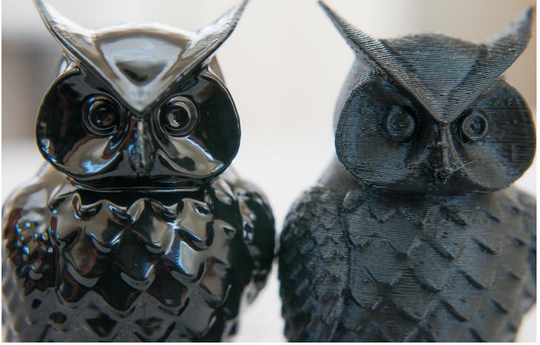
Fotoğraf 2.9. 3B modelin aseton buharı ile kaplanması [22]
