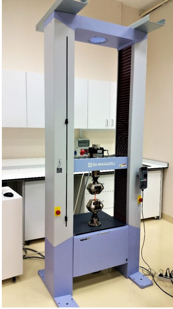
Fotoğraf 4.9. SHIMADZU marka Autograph AGS-X model universal test cihazı
