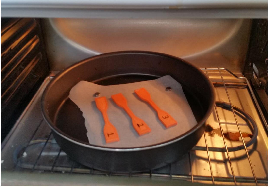
Fotoğraf 5.1. Numunelerin fırınlanma işlemi
