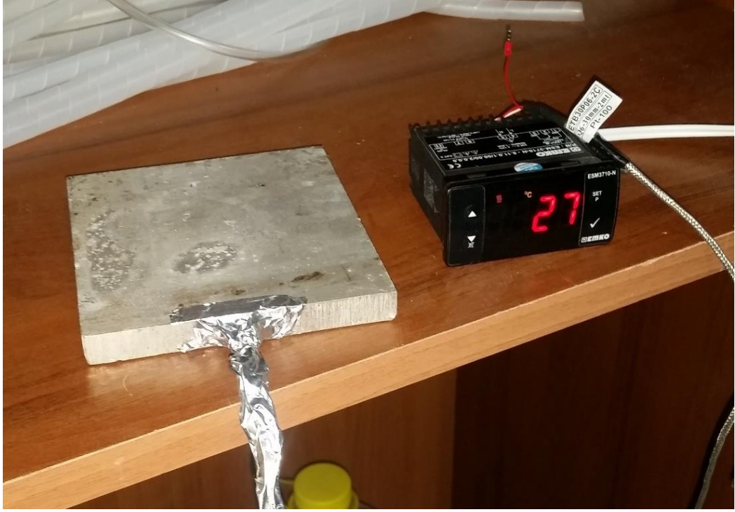
Fotoğraf 4.7. Alüminyum tabanlı dijital ısıölçer
