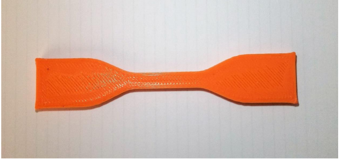
Fotoğraf 4.1. ASTM D638 Type 4 çekme testi numunesi
