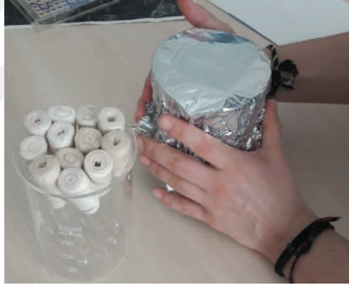
Fotoğraf 3.3. Deney tüplerinin otoklav için alüminyum folyo ile kapatılması
